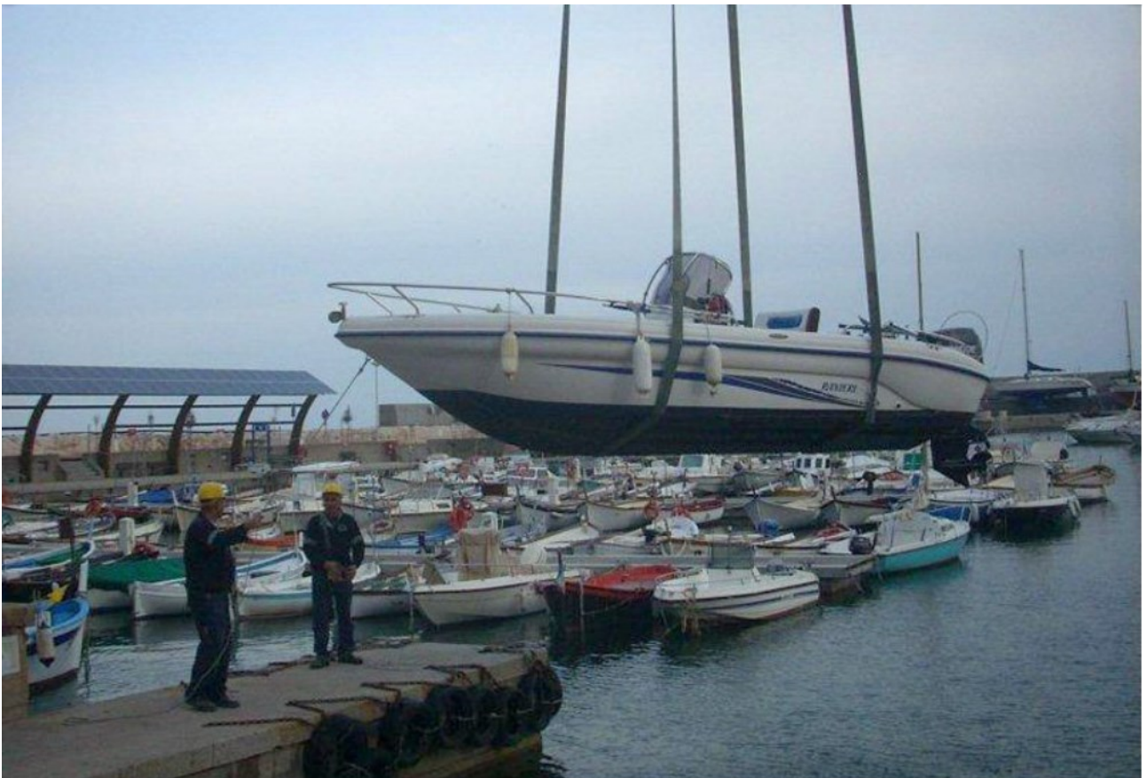
Gru fissa da 3,5 tonnellate per la movimentazione delle imbarcazioni
