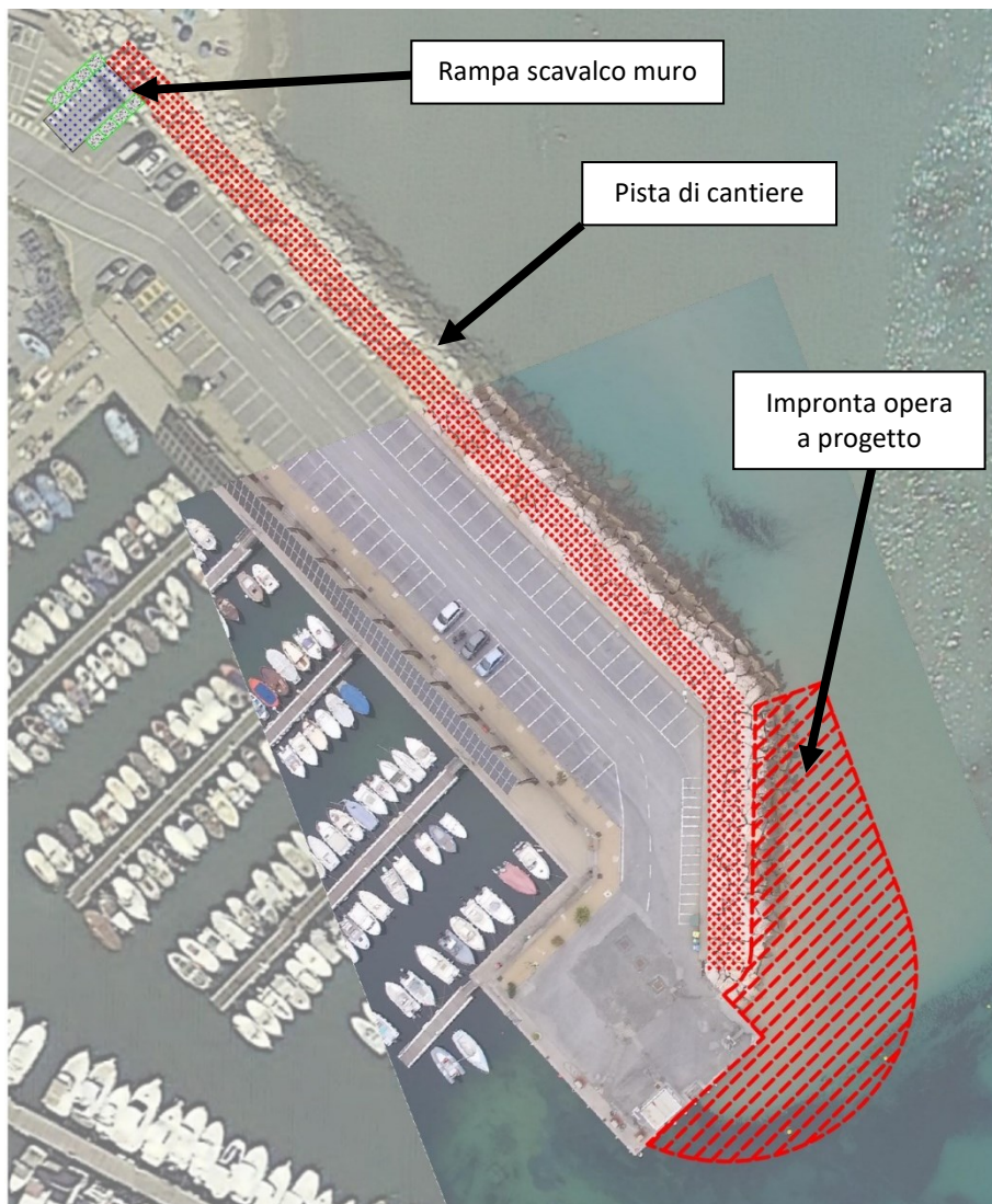
Rampa di scavalco e pista di cantiere, entrambe provvisorie
