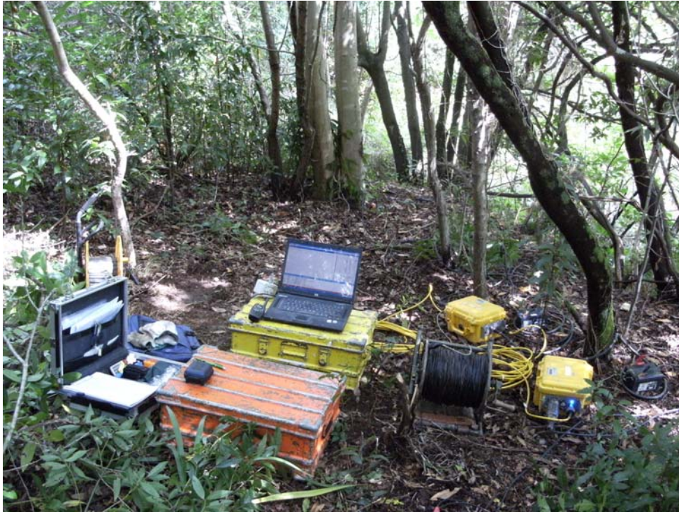
Figura 2.1 – Acquisizione dati sismica a rifrazione: particolare della strumentazione utilizzata con notebook e sismografi GEODE.
