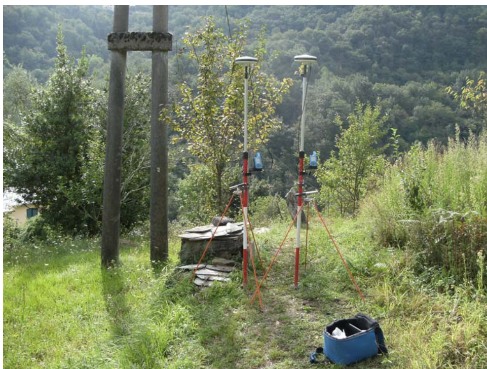
Figura 3.1 – Base del sistema GPS a doppia stazione
