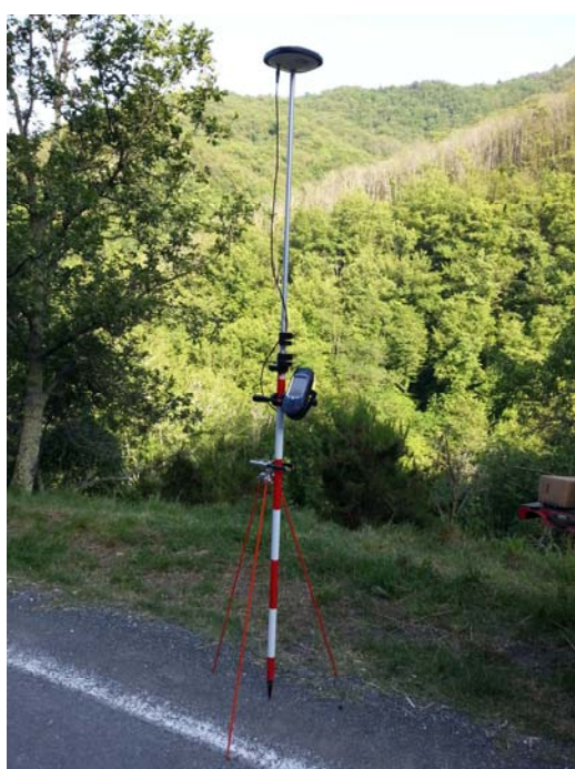
Sistema GPS ProMark3 utilizzato per i rilievi
