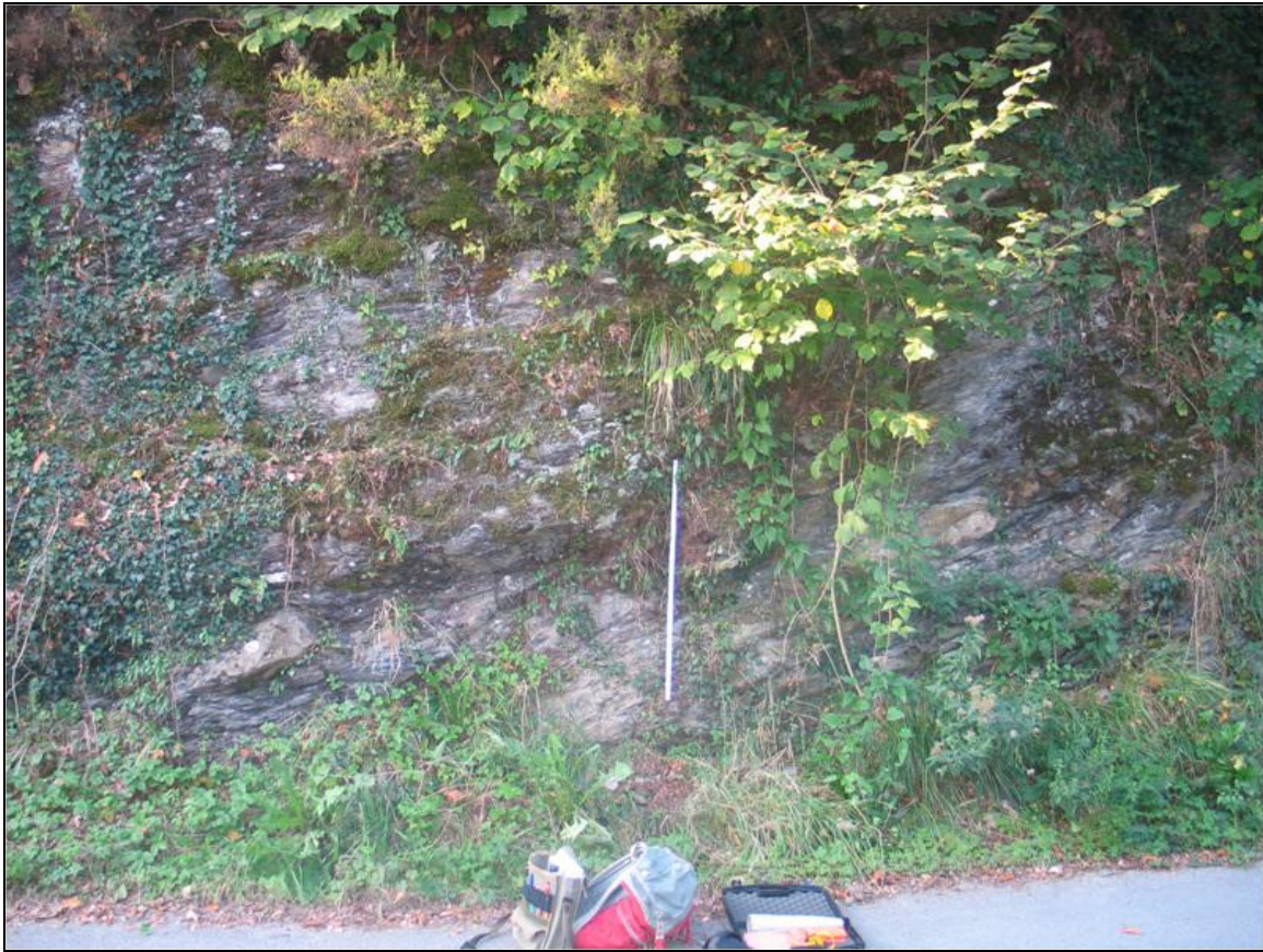
Fotografia dell'affioramento in corrispondenza del rilievo geomeccanico RG1 - Metasiltiti grigio-verdastre fittamente laminate con subordinate intercalazioni di metaareniti fini in strati decimetrici.
