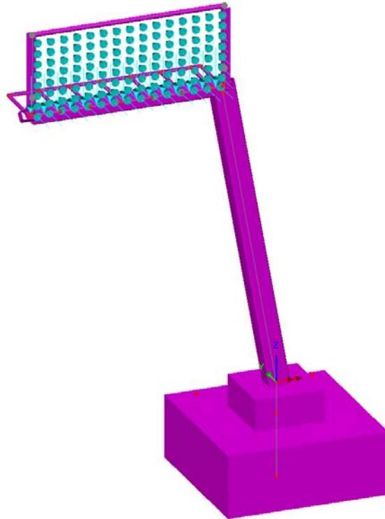
**Fig. 11 – Azione di Buffeting - Corsia 1**
