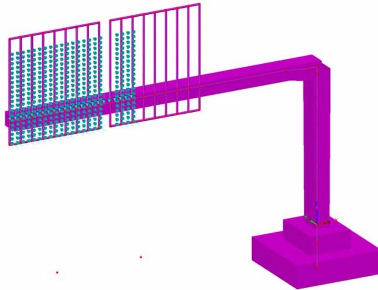
**Fig. 12 – Azione di Buffeting - Corsia 2**
