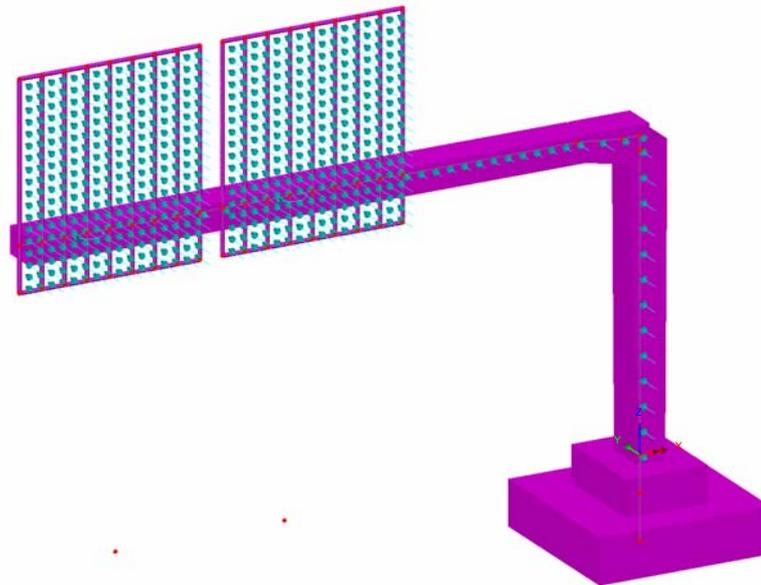
**Fig. 7 – Azioni del vento sulla struttura**
