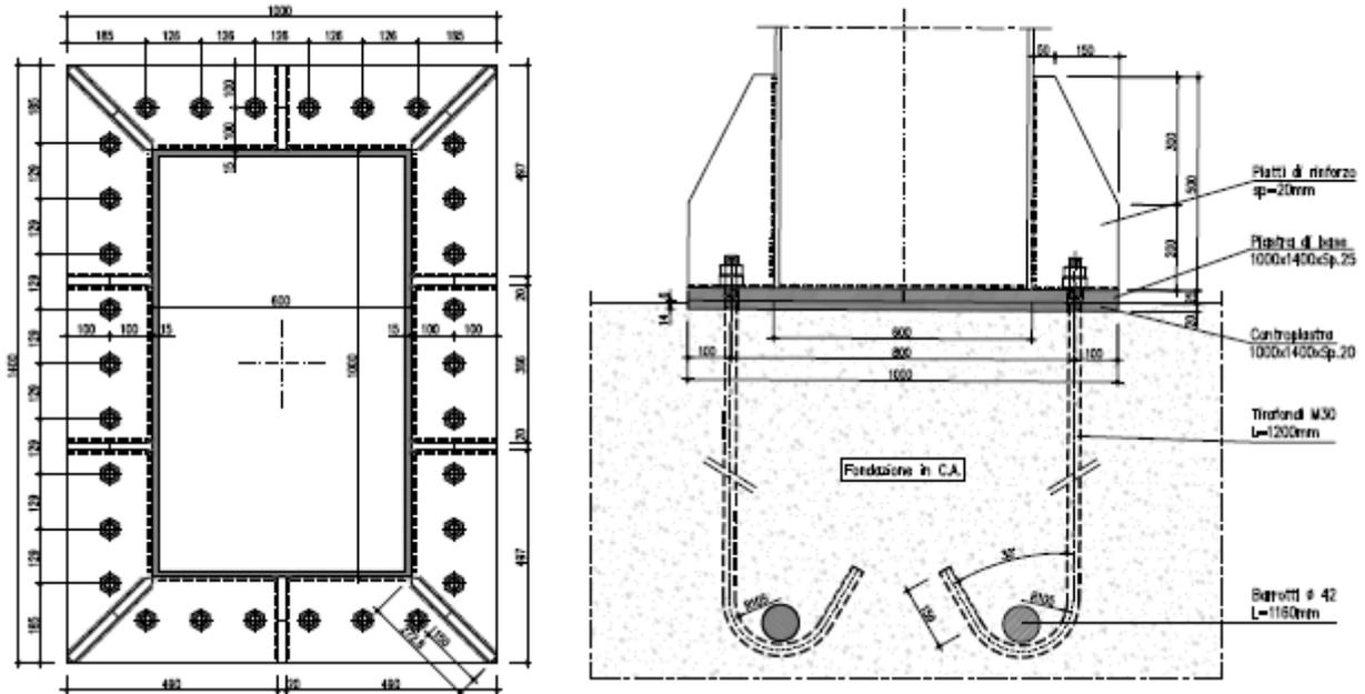
**Fig. 4 – Dettaglio della connessione alla base**
