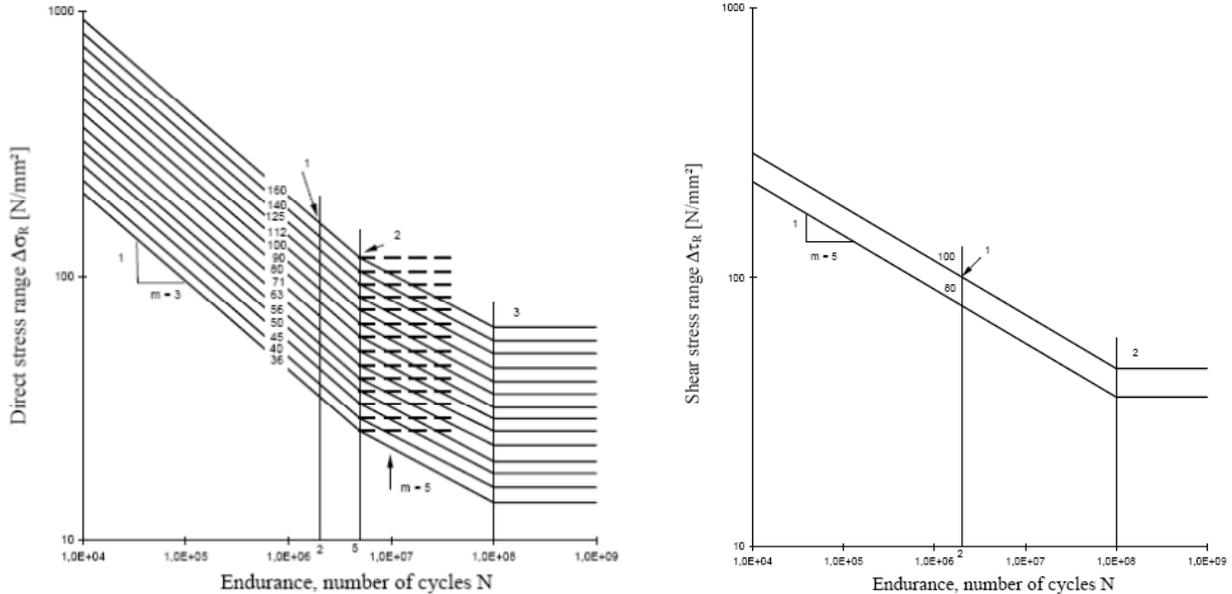
Fig. 66 – Curve di resistenza a fatica S-N per tensioni normali e tangenziali
