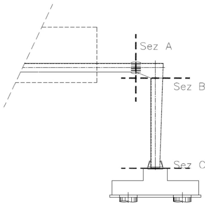
Fig. 53 – Sezioni di verifica - giunzioni bullonate
