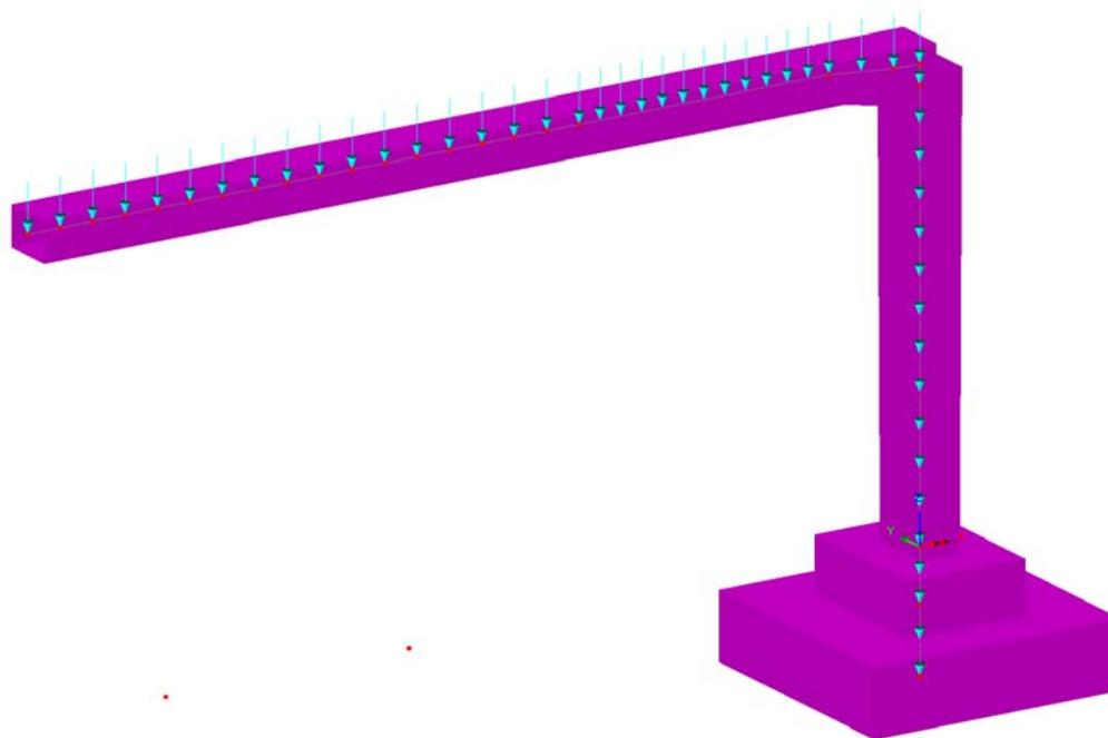
**Fig. 5 – Peso proprio degli elementi strutturali**
