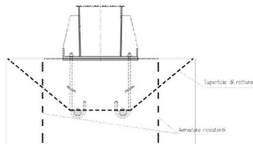
Rottura per fessurazione da carico:
