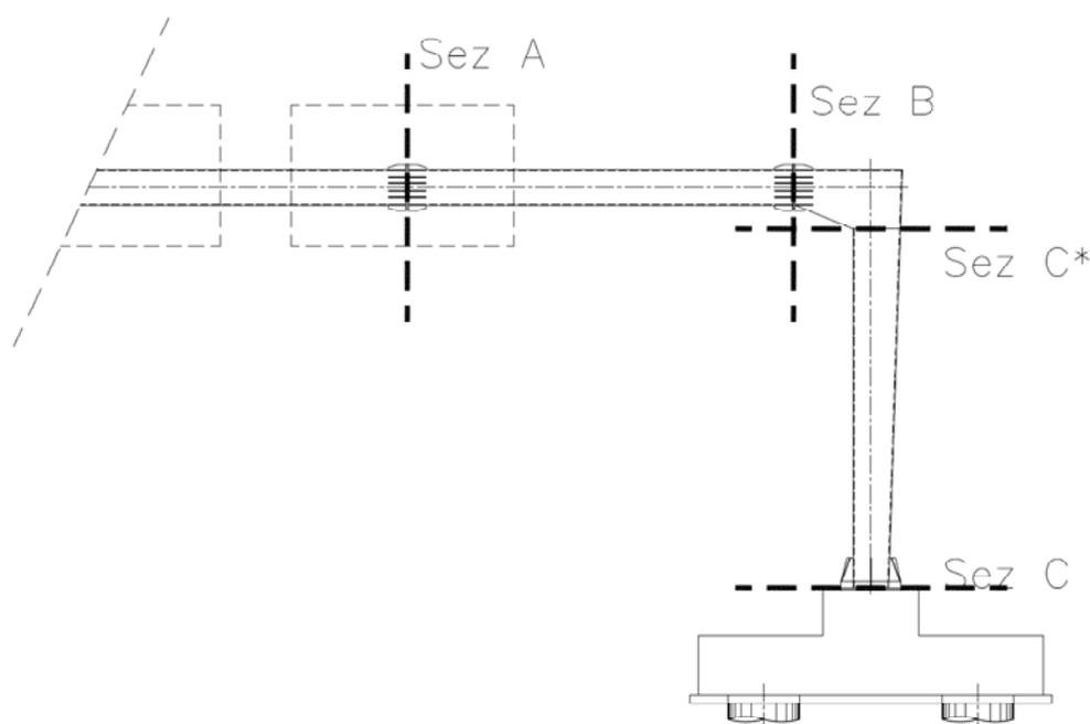
Fig. 57 – Sezioni di verifica - giunzioni bullonate
