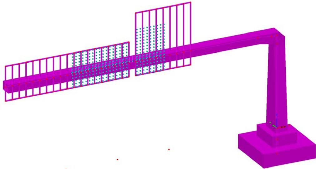
**Fig. 12 – Azione di Buffeting - Corsia 2**
