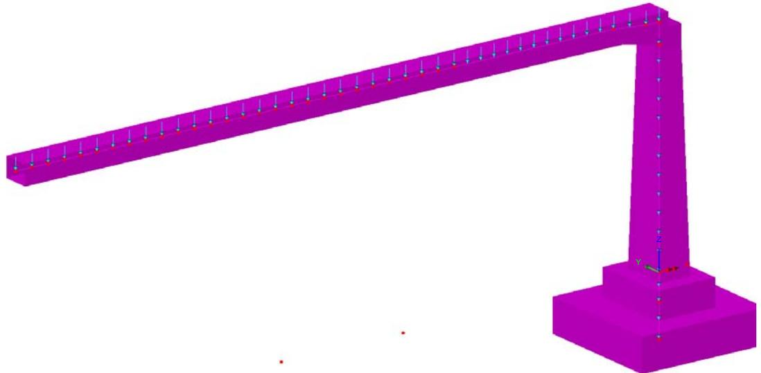
**Fig. 5 – Peso proprio degli elementi strutturali**
