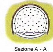
Jet-grouting sub-orizzontale al contorno della cavità e nel nucleo-fronte
