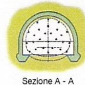
Rinforzo del terreno con elementi strutturali di vetroresina al contorno della cavità e nel nucleo
