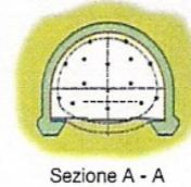
Jet-grouting sub-orizzontale al contorno della cavità e rinforzo del nucleo-fronte mediante elementi strutturali di vetroresina
