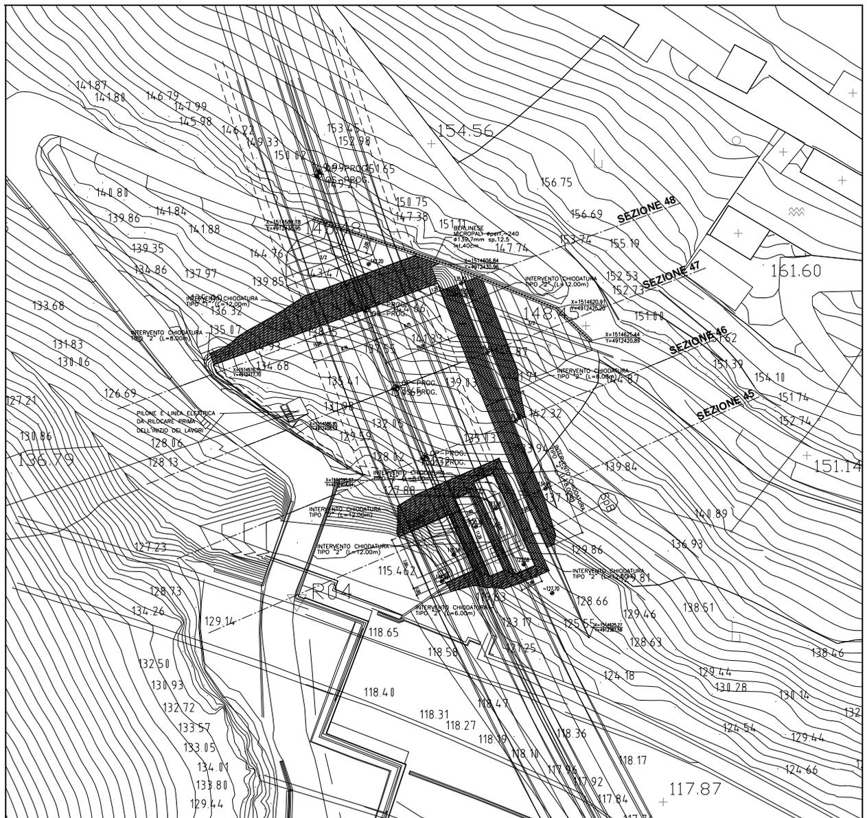
**Figura 2: Disposizione planimetrica delle opere di imbocco**
