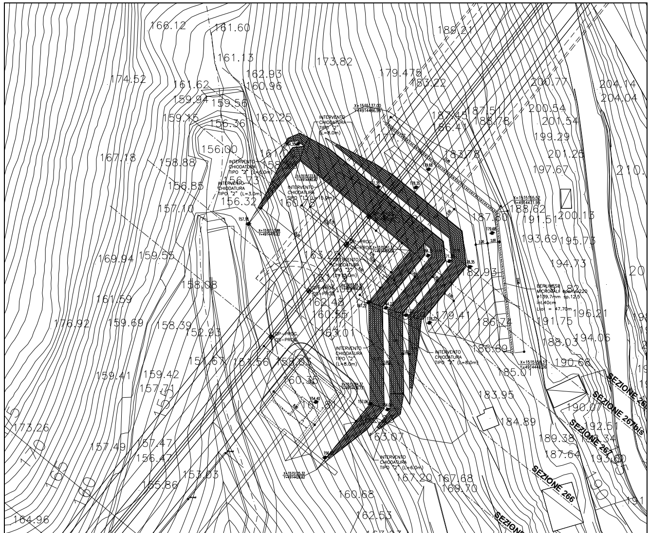
Figura 2: Disposizione planimetrica delle opere di imbocco
