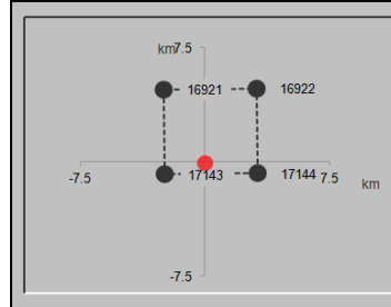
Figura 16: Punti della griglia di nodi prefissati nell'intorno del interesse sito di progetto (tratto da Spettri di risposta – V. 1.0.3.xls)
