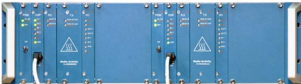
Figura 4: Stazione Radio Base per installazione a rack 19''
