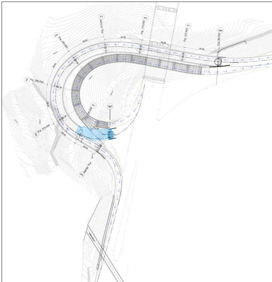
Figura 5-16 Realizzazione campate da P7 a SPB e completamento soletta (Fase 4)
