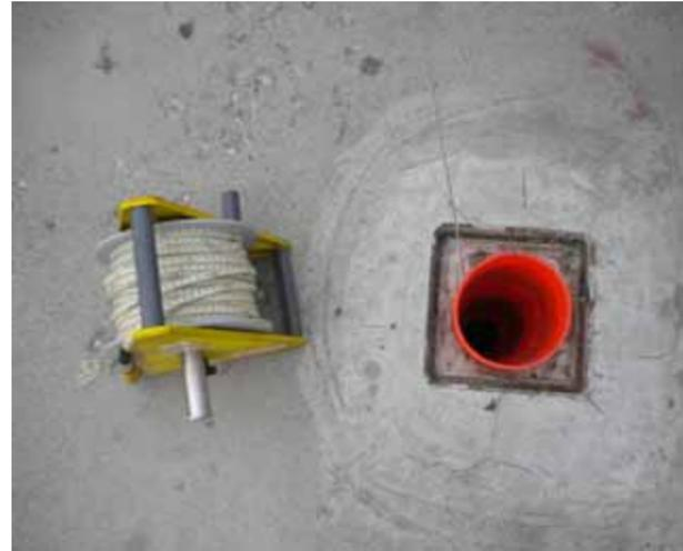
Predisposizione della testa piezometro per l'esecuzione di una prova di permeabilità (*slug test*)
