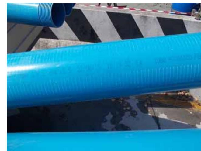
Dettaglio del tubo piezometrico in PVC microfessurato (luce 0.25 mm)
