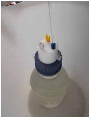
Dettaglio del tappo munito di valvole per evitare contaminazione indotta dall'atmosfera sito-specifica
