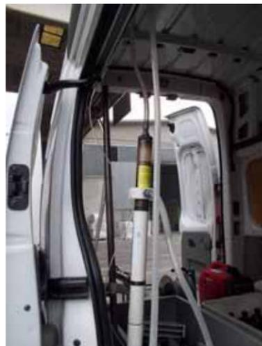
Cella di flusso per il monitoraggio dei parametri fisico-chimici nella fase di spurgo pre-campionamento
