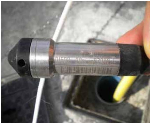
Dettaglio del sensore di livello installato ai fini del monitoraggio dell'andamento del livello di falda
