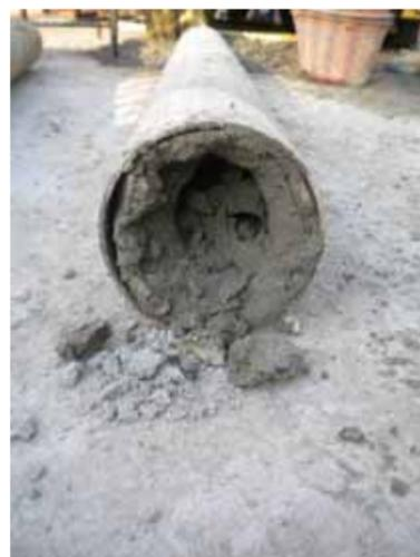
Dettaglio del carotiere per l'avanzamento a carotaggio continuo
