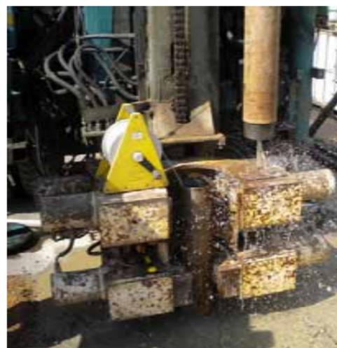
Esecuzione prova di permeabilità Lefranc in SD2
