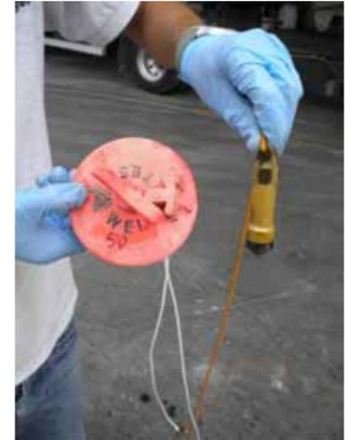
Sensore di livello installato per la verifica dei livelli di falda
