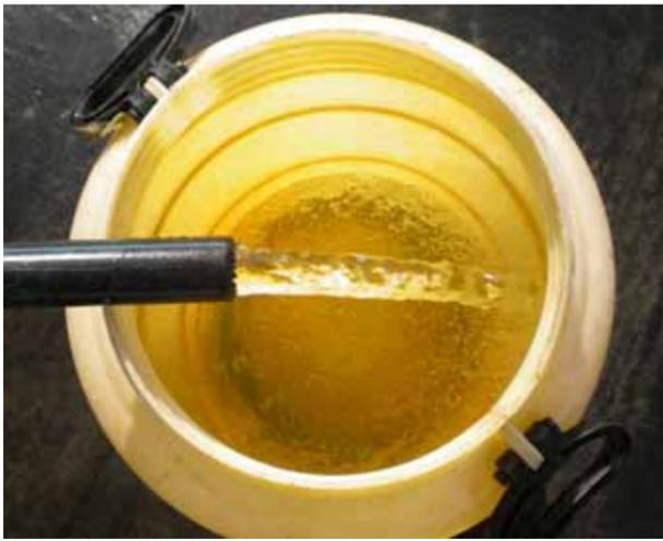
Stoccaggio acque di spurgo prelevate con pompa Grundfos 3"
