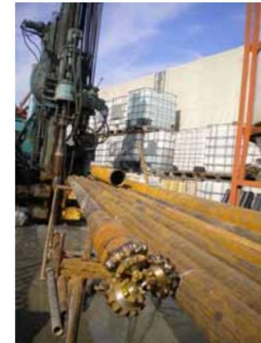
Tricono di perforazione utilizzato nei sondaggi a distruzione di nucleo
