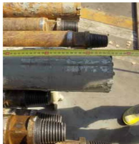
Dettaglio del carotiere (Ø 101 mm)
