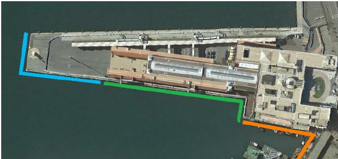
Figura 1. Massi sovrapposti in cls (indicata col colore arancione) - Struttura a giorno in c.a. fondata su pali in aggetto ai massi sovrapposti (realizzata postuma ai massi sovrapposti, indicata col colore verde) - Cassoni cellulari in c.a. (indicata col colore azzurro).
