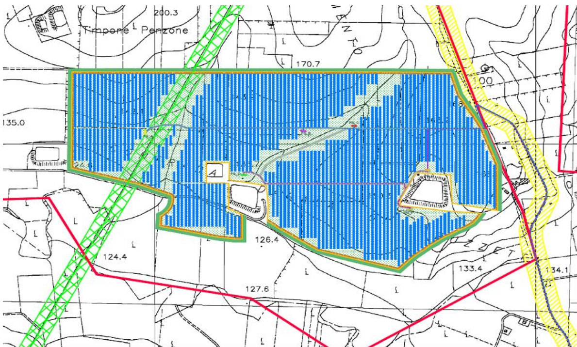
Figura 2 layout impianto fotovoltaico su CTR
