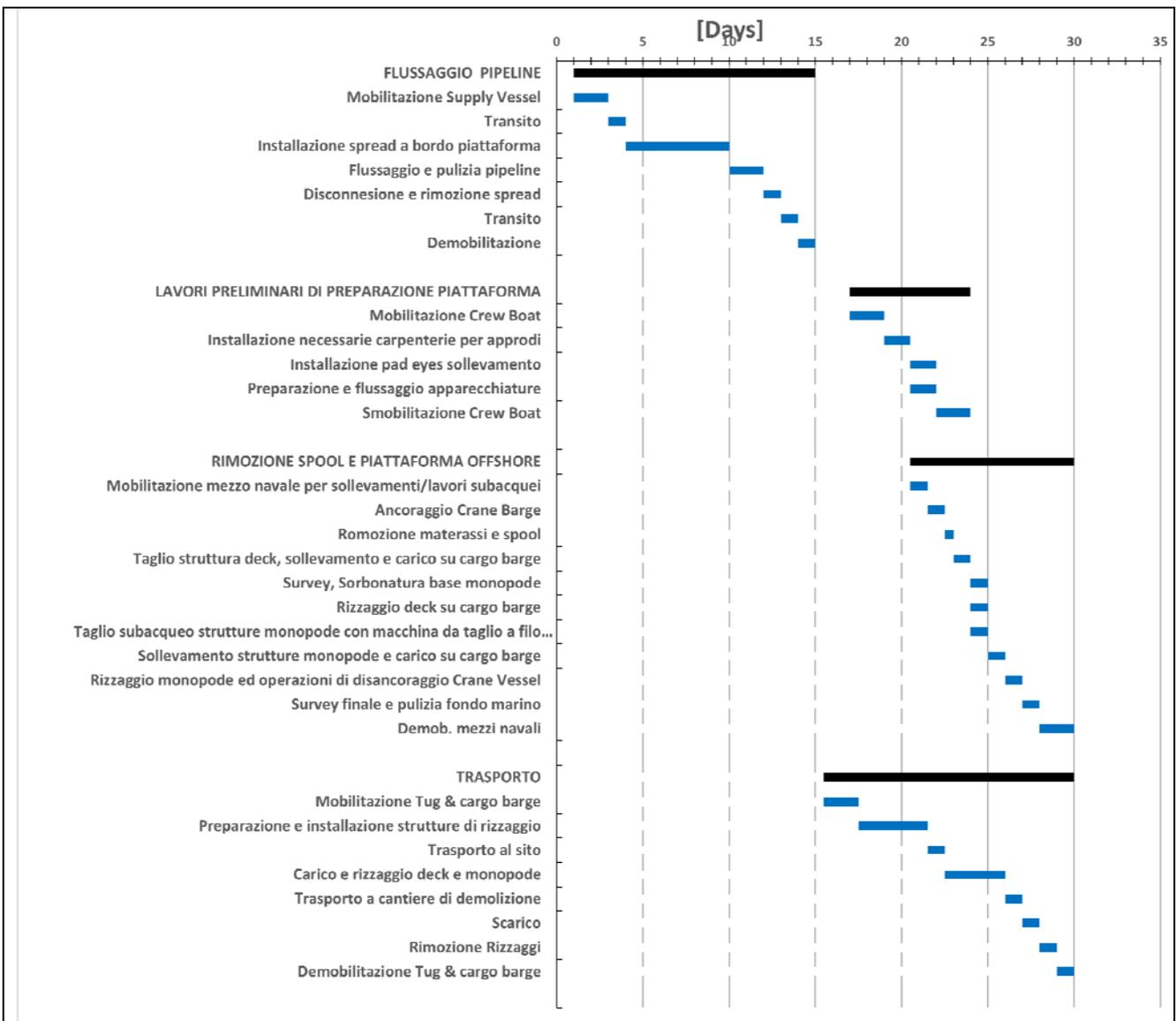
Il metodo individuato per la rimozione della Piattaforma PC-73 consiste nel procedere alla rimozione della piattaforma in due sezioni, attraverso taglio della struttura e sollevamento mediante utilizzo di una nave gru. Nel dettaglio, sono previste le seguenti attività:
