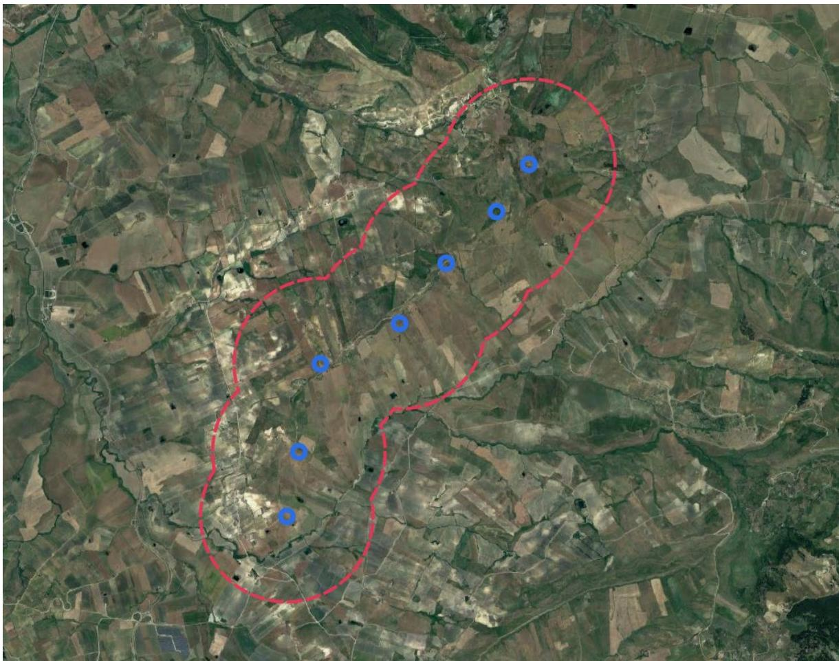
**Figura 1** – inquadramento su fotopiano degli aerogeneratori di progetto (in blu) e dell'area d'influenza del parco (in rosso) pari al raggio di 1 km da ogni aerogeneratore.
