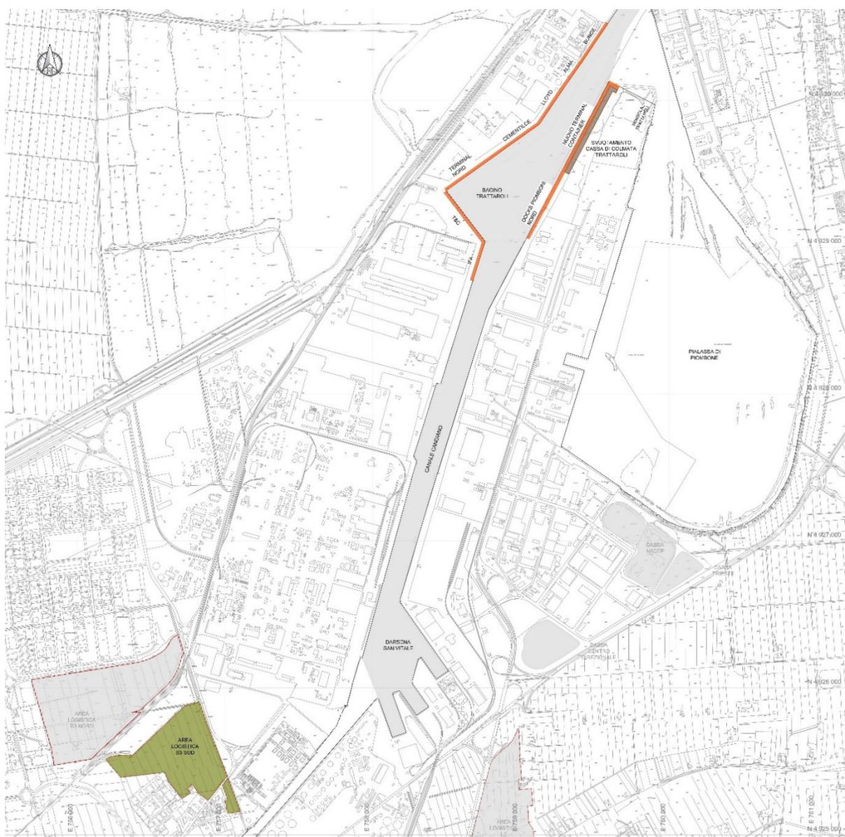
Figura 3 – Corografia di progetto relativa alle banchine da adeguare, al nuovo terminal in penisola Trattaroli, allo svuotamento della cassa Trattaroli e al conferimento del materiale nell'area logistica S3 – consegna 28/07/21
