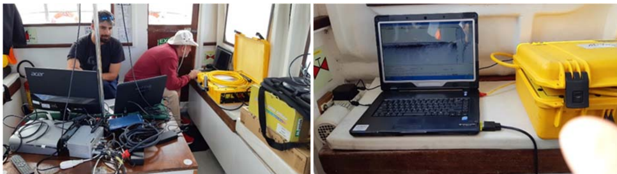
Figura 20: equipaggiamento per l'indagine SBP, collegata tramite seriale al sistema di navigazione
