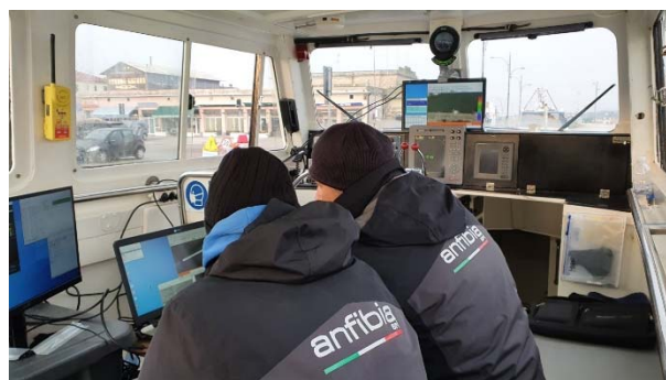
Figura 25: la M/B Alicante della Ciappini, armata col nostro sistema per i rilievi batimetrici MBES
