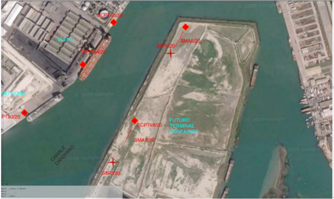
Figura 29: ubicazione della linea sismica SMA5 e SMA6
