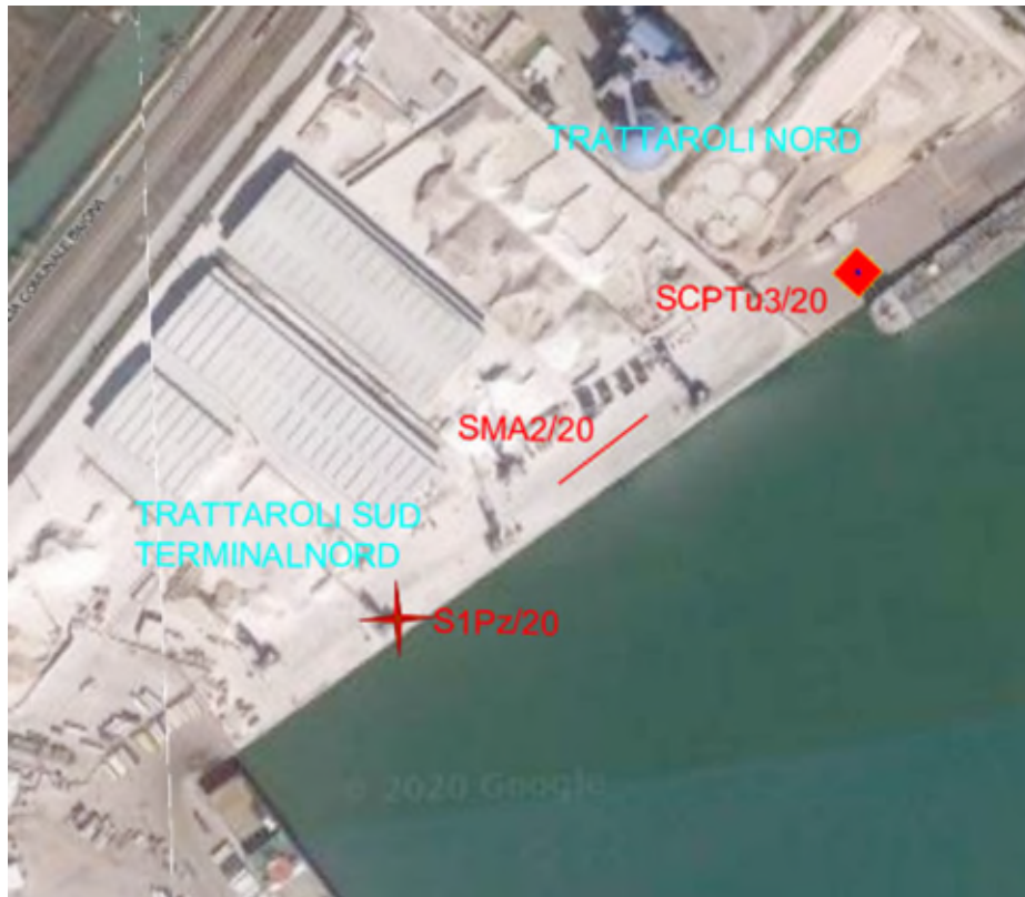
Figura 14: ubicazione della linea sismica SMA2
