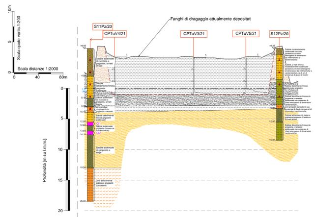
SEZIONE GEOTECNICA "D" - CENTRO DIREZIONALE
