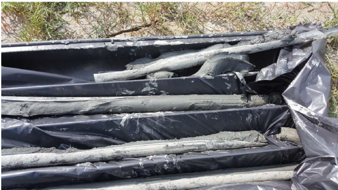
Fig. 2-3 - Cassa Centro Direzionale – Cassetta sondaggio C03
