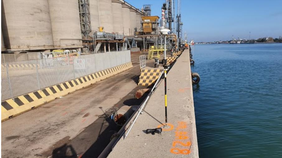
**Figura 49: HUB\_ba28, uno dei caposaldi materializzati e battuti sulla banchina**
