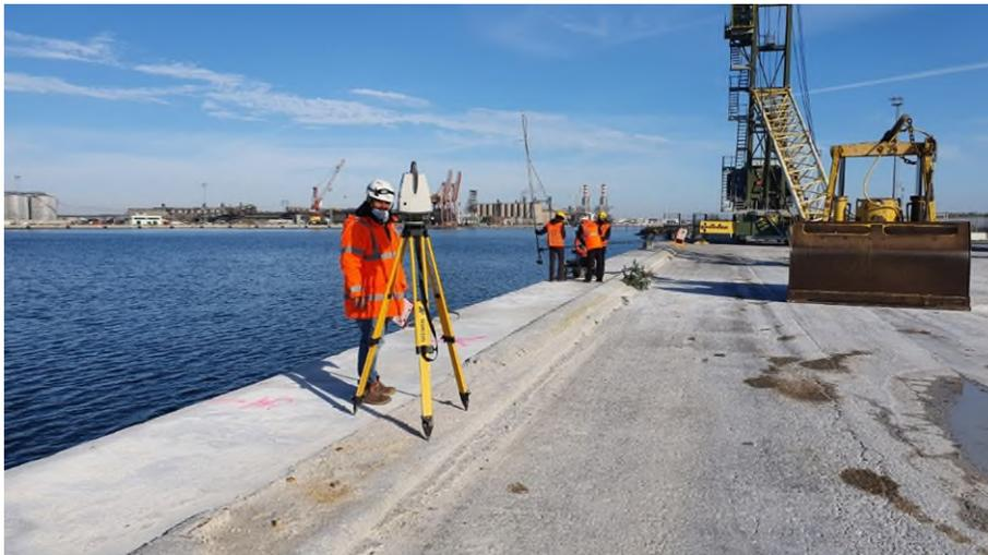
**Figura 6: il Laser Scanner Terrestre in stazione su una banchina**
