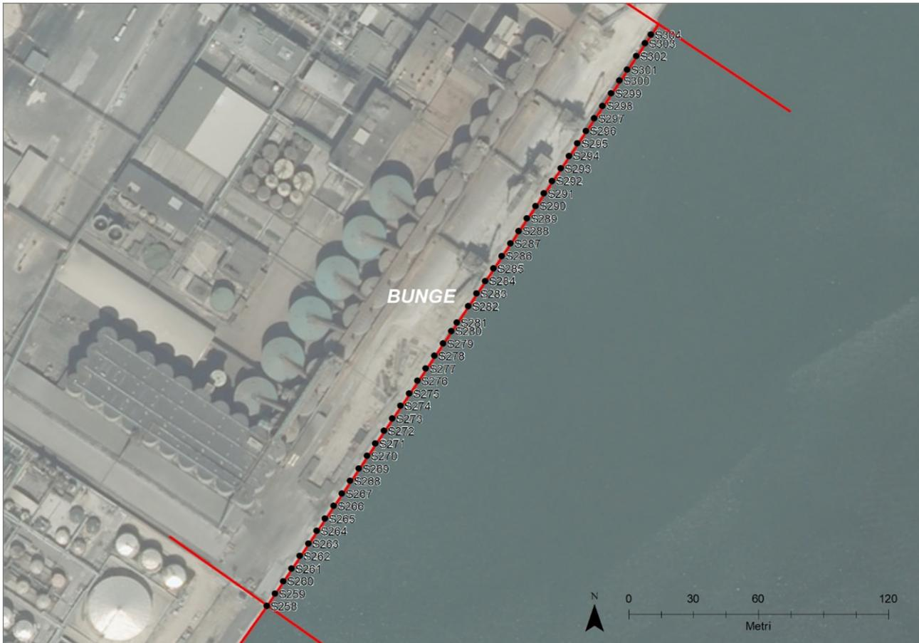
**Figura 60: distribuzione delle stazioni sonar lungo la banchina**
