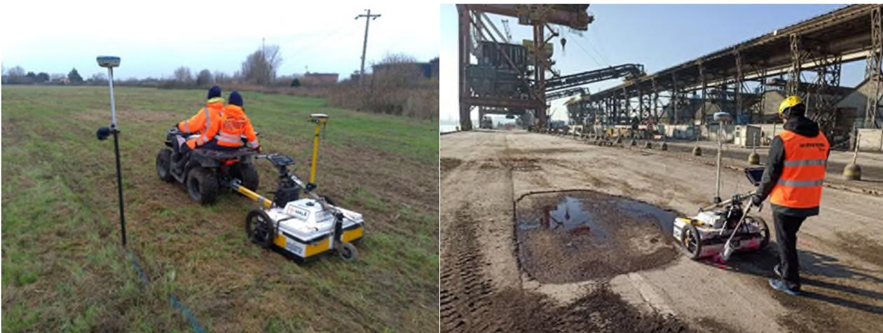
**Figura 48 modalità di acquisizione a traino (a sinistra) e manuale (a destra)**
