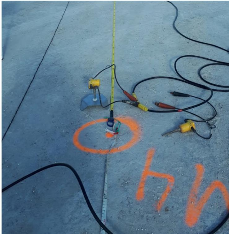
**Figura 64: geofono su bassetta metallica**
