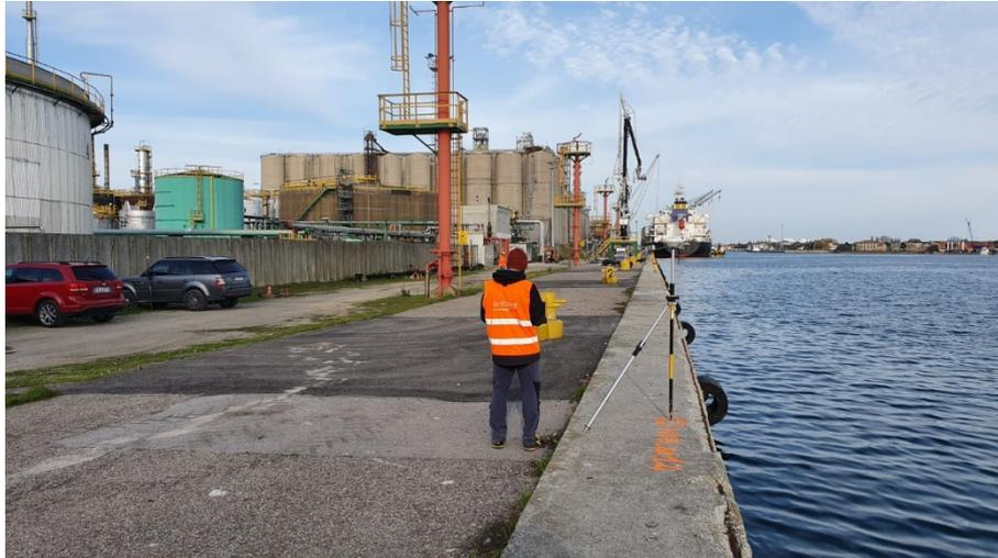
Figura 42: HUB\_ba14, uno dei caposaldi materializzati e battuti sulla banchina
