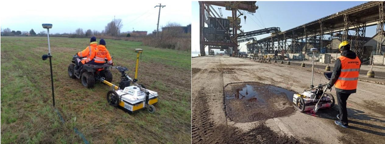
Figura 41 modalità di acquisizione a traino (a sinistra) e manuale (a destra)
