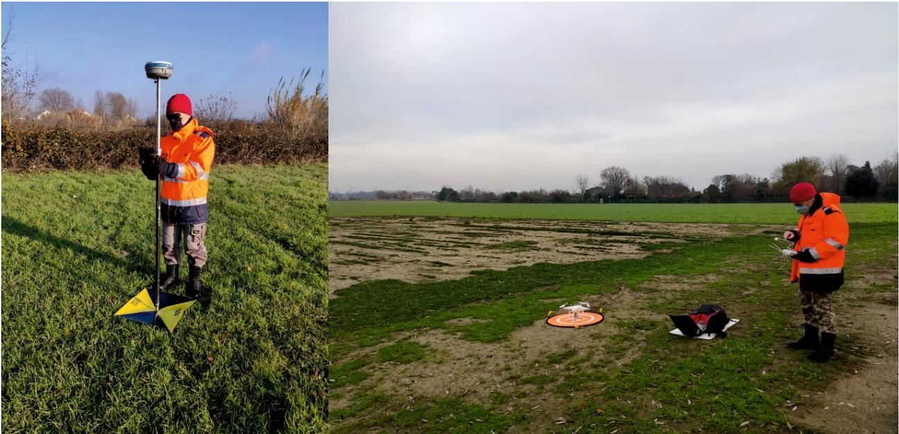
**Figura 14** Fasi dell'acquisizione: rilevamento GCP (a sx), esecuzione del volo (a dx).
