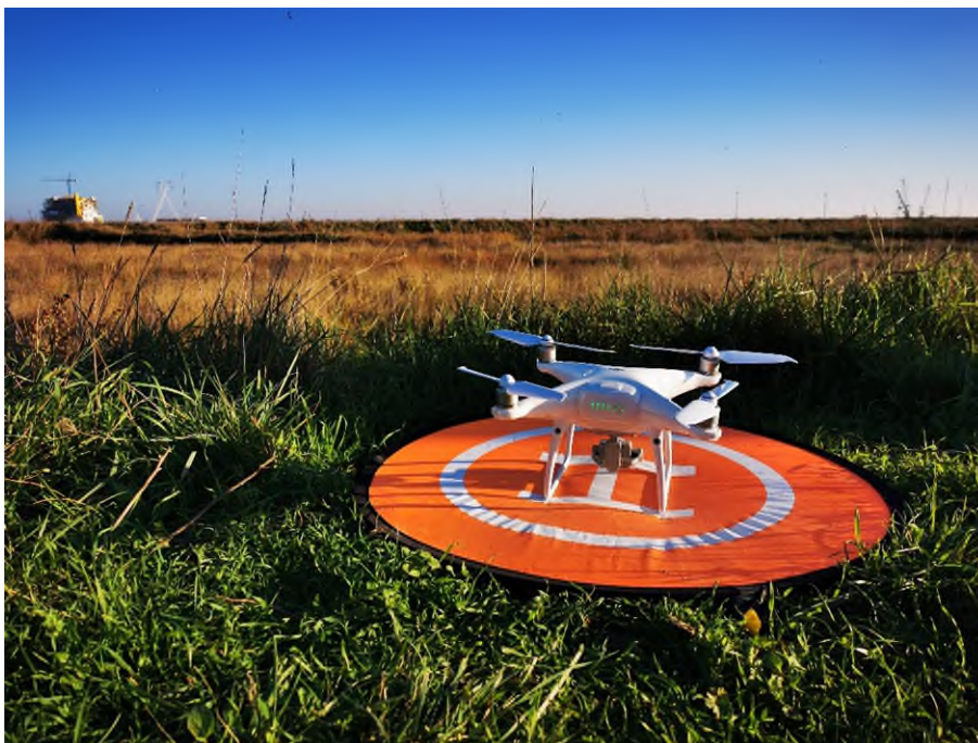
Figura 12: Il DJI Phantom 4 Pro, UAS utilizzato per i rilievi aerofotogrammetrici.
