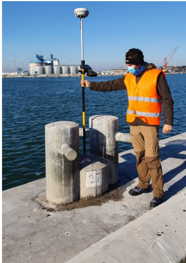
Figura 4: tecnica di misura delle bitte – asse testa
