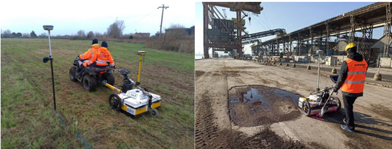
Figura 41: modalità di acquisizione a traino (a sinistra) e manuale (a destra)
