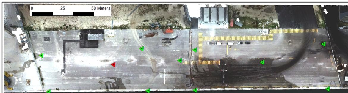
**Figura 48** Distribuzione dei GCP e Check Point all'interno dell'ambito rilevato
