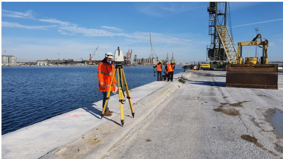
Al fine di georeferenziare l'intera nube di punti, in fase di rilievo vengono acquisite le posizioni di punti noti, posizionando su di essi un target per strumentazione scanner.
