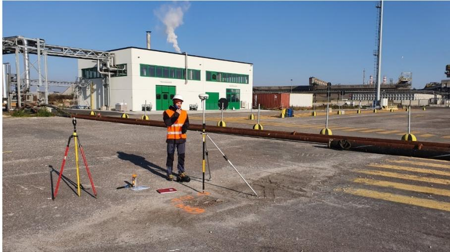
Figura 42: HUB\_ba19, uno dei caposaldi materializzati e battuti sulla banchina
