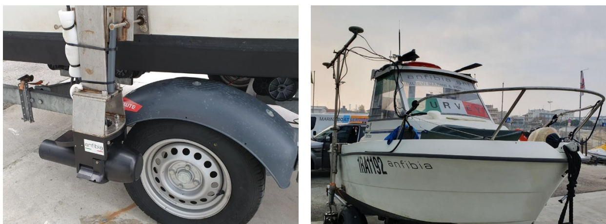
Figura 24: la testa (a sx) e l’intero supporto (a dx) del sistema multi beam Norbit iWBMS
