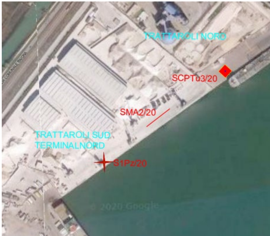
Figura 67: ubicazione della linea sismica SMA2
