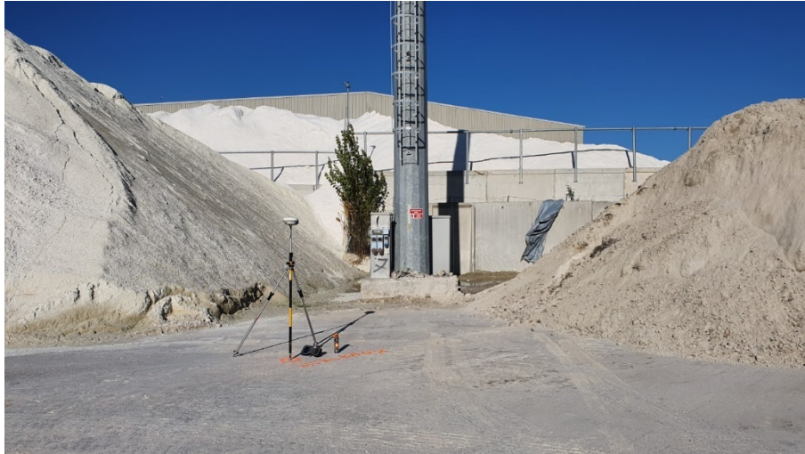
Figura 49: HUB_ba7, uno dei caposaldi materializzati e battuti sulla banchina
