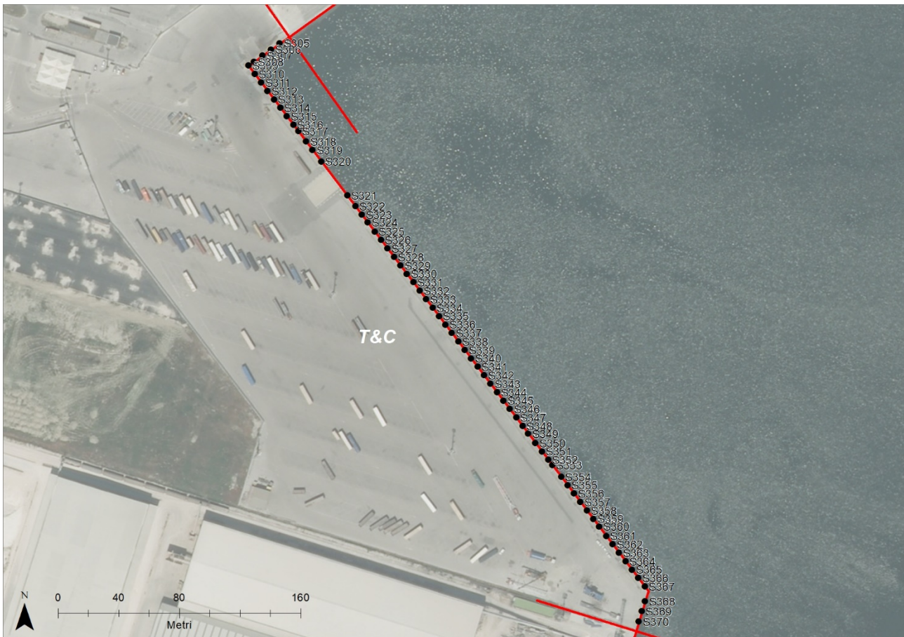
Figura 64: distribuzione delle stazioni sonar lungo la banchina
