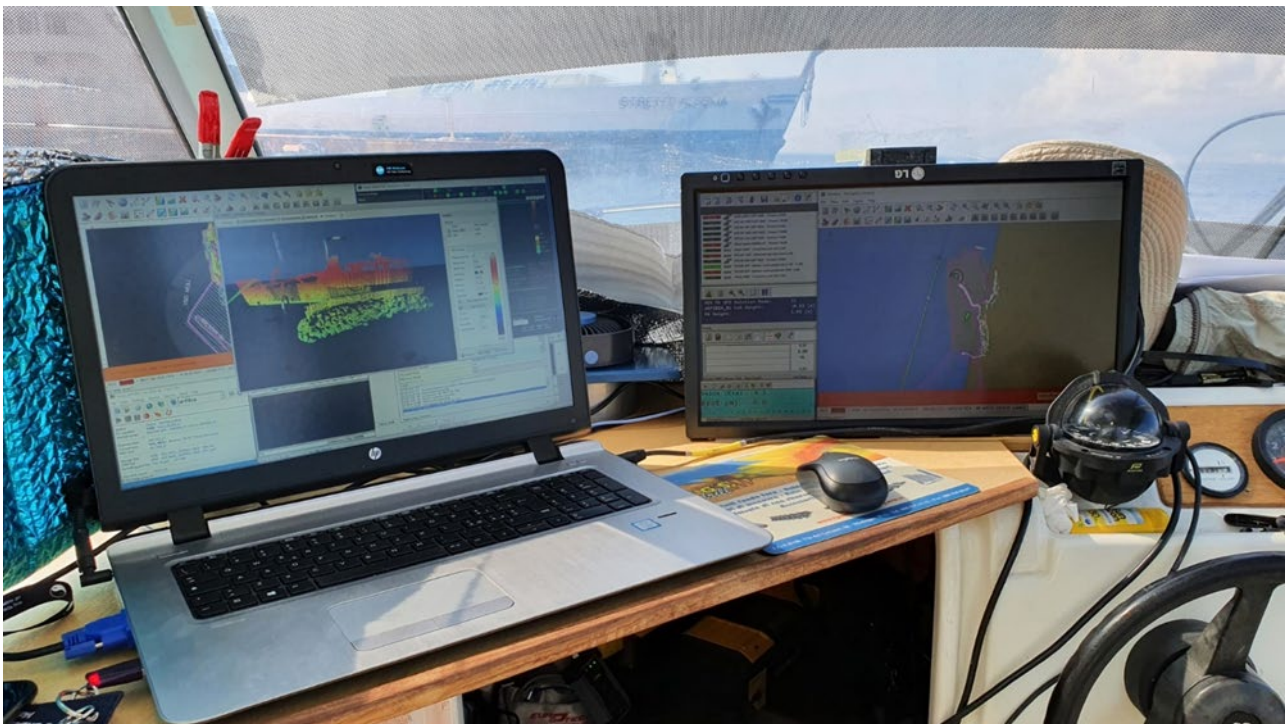
Figura 26: l'interfaccia grafica del programma di navigazione QPS Qinsy, installato in plancia
