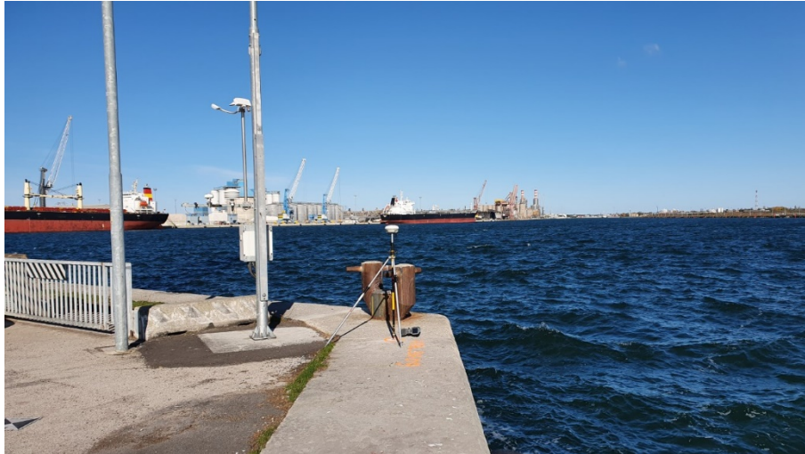
Figura 49: HUB_ba9, uno dei caposaldi materializzati e battuti sulla banchina
