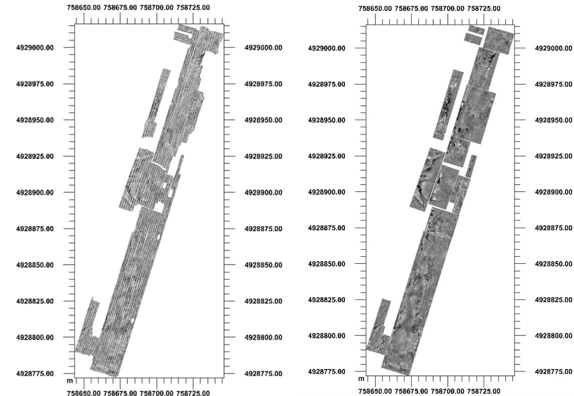
**Figura 59 dato GPR raw e dato GPR interpolato**
