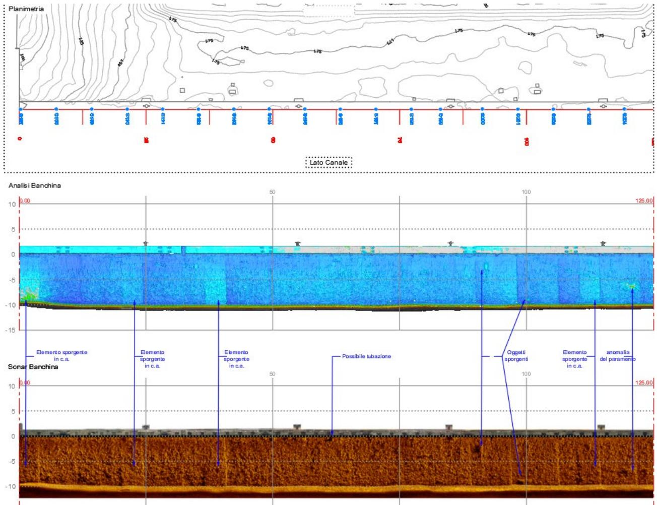
Figura 55: stralcio della Tavola AN\_BAN\_I – in alto la planimetria, al centro mesh multibeam e lidar, in basso mosaicitura sonar e fotografica
