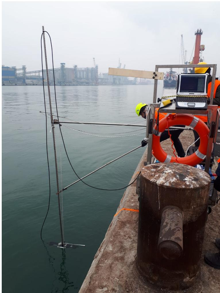
**Figura 54: acquisizione dati con MS1000**
