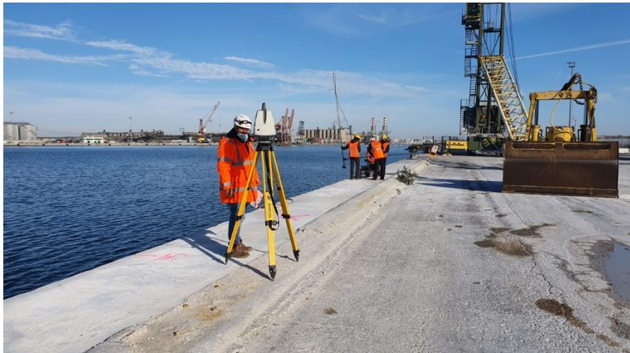
Al fine di georeferenziare l'intera nube di punti, in fase di rilievo vengono acquisite le posizioni di punti noti, posizionando su di essi un target per strumentazione scanner.
