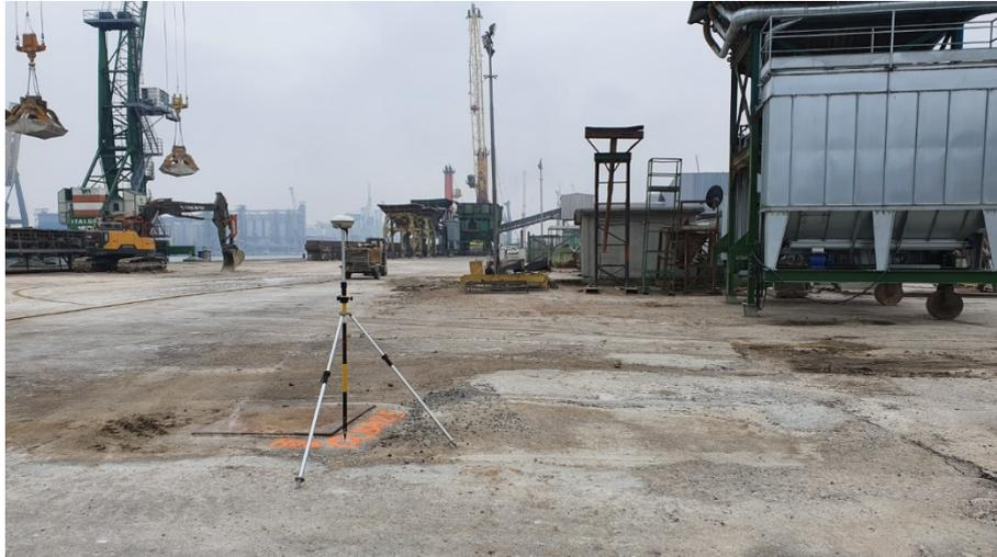
Figura 42: HUB\_ba25, uno dei caposaldi materializzati e battuti sulla banchina
