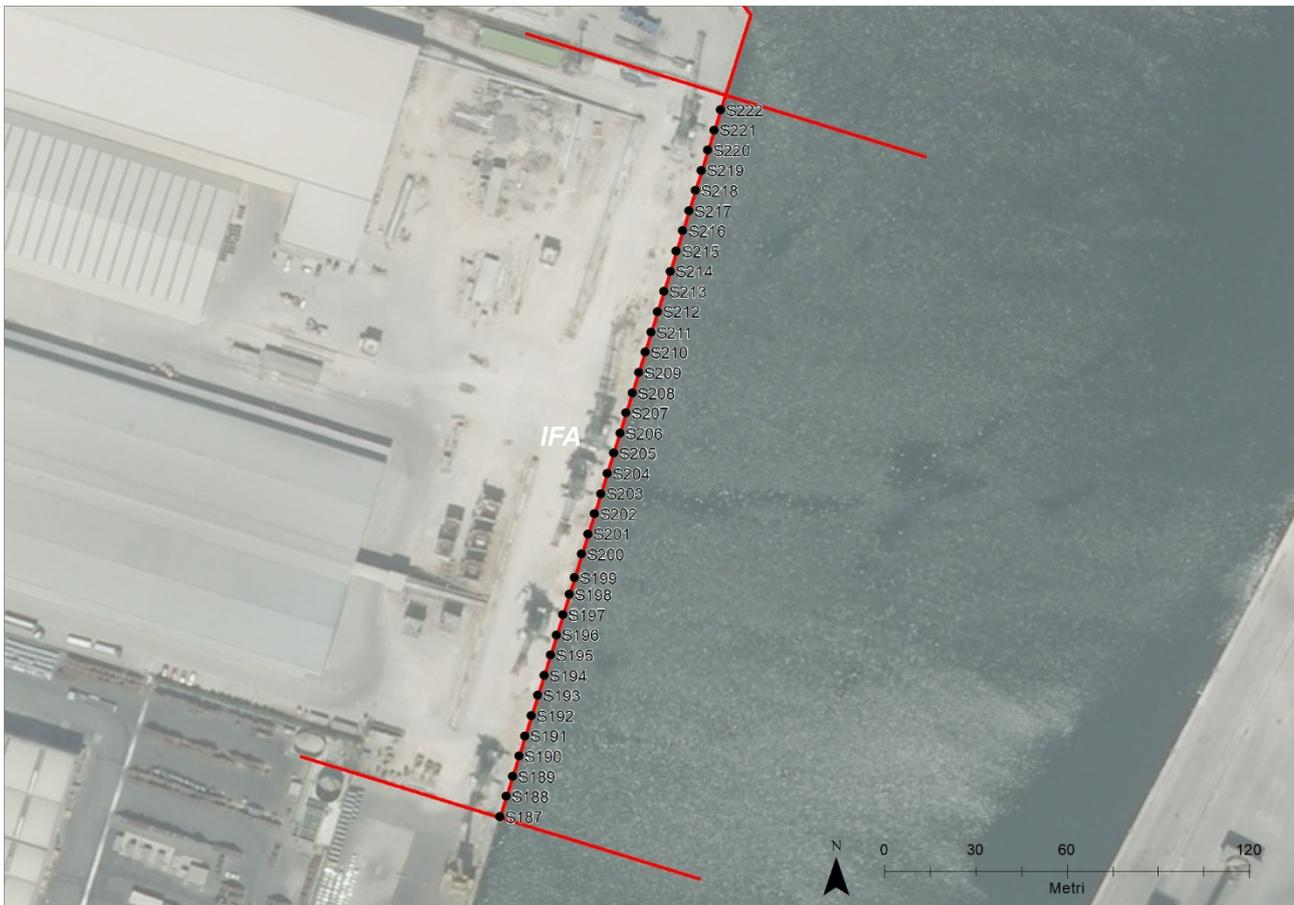
**Figura 53: distribuzione delle stazioni sonar lungo la banchina**
