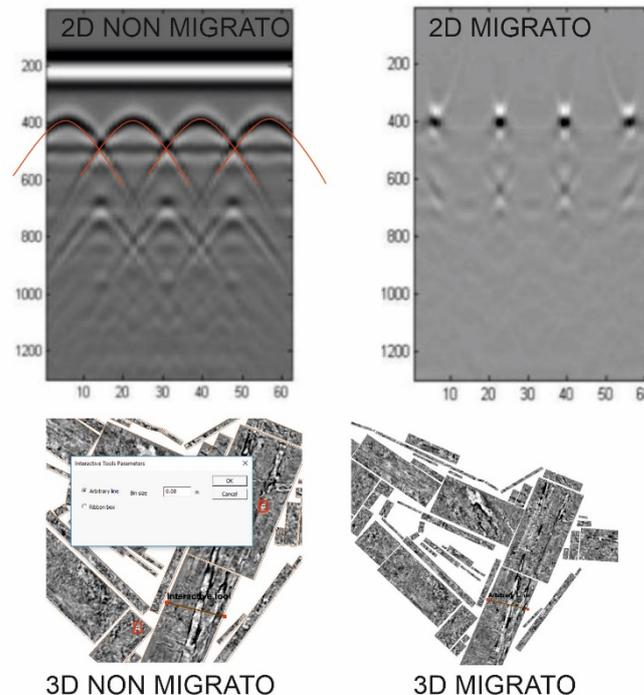
**Figura 39** In alto: confronto tra dato 2D non migrato e migrato dopo l'analisi delle iperboli di diffrazione; in basso: visualizzazione delle slice 3D non migrate e migrate in seguito all'analisi delle iperboli di diffrazione.
