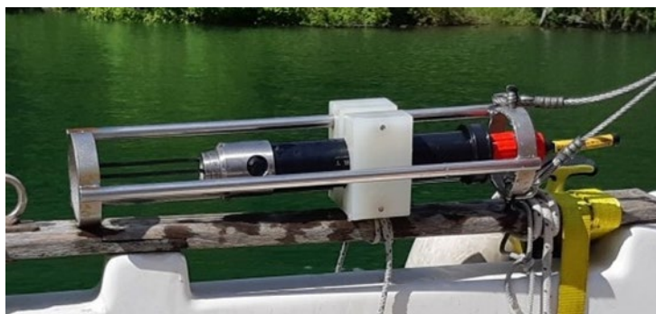
Figura 25: il profilatore acustico Valeport Mini SVP
