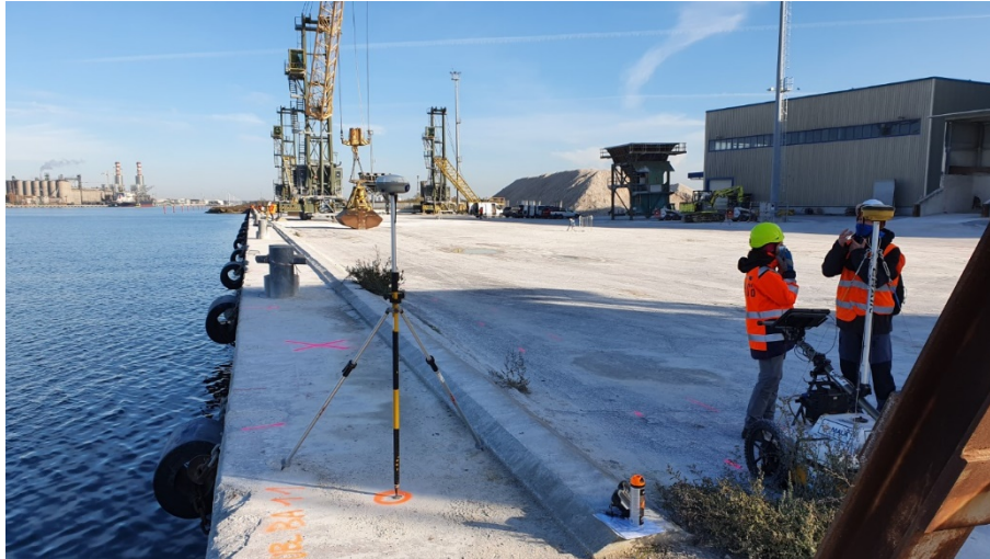
Figura 49: HUB_ba11, uno dei caposaldi materializzati e battuti sulla banchina
