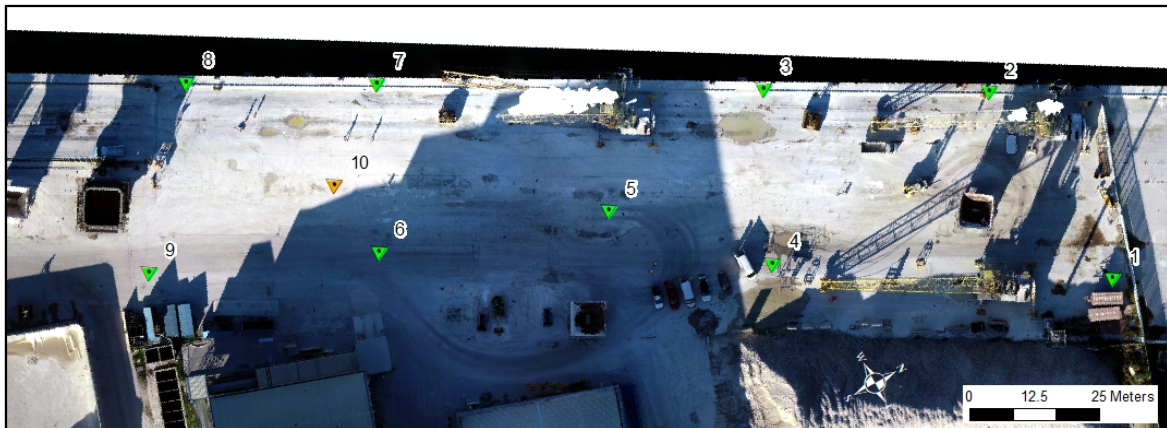
Figura 55 Distribuzione dei GCP e Check Point all'interno dell'ambito rilevato
