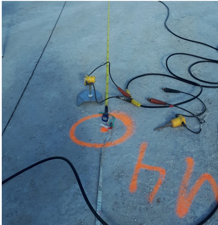
Figura 68: geofono su bassetta metallica
