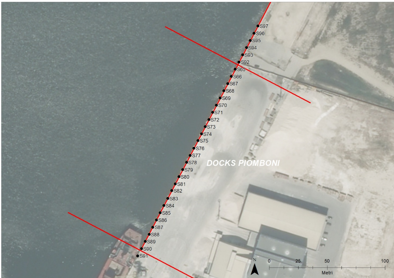
Figura 64: distribuzione delle stazioni sonar lungo la banchina
