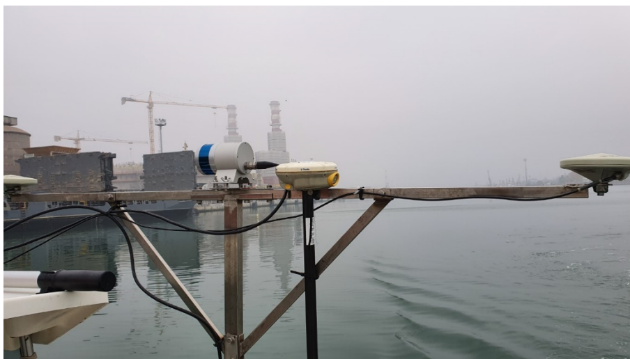
Figura 7: il sensore Lidar installato rigidamente in testa al palo del sistema batimetrico multi beam
