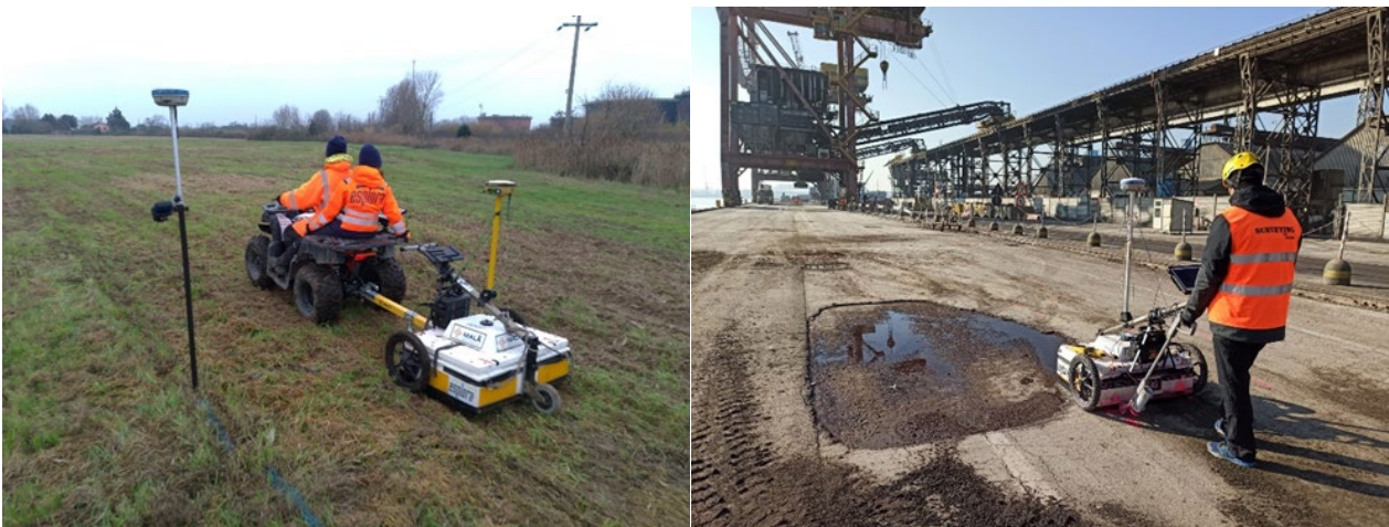
Figura 48: modalità di acquisizione a traino (a sinistra) e manuale (a destra)
