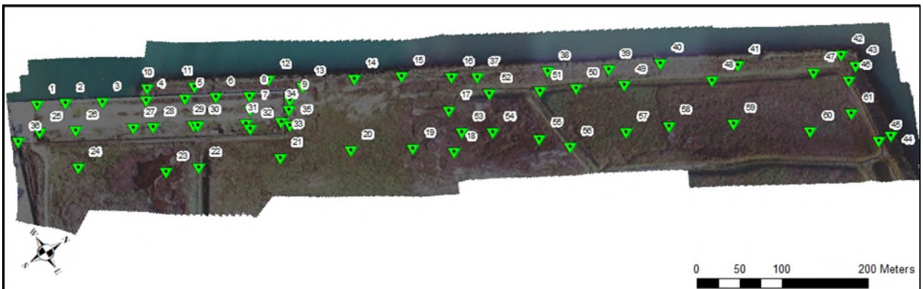
Figura 47 Distribuzione dei GCP e Check Point all'interno dell'ambito rilevato
