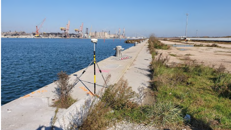
Figura 41: HUB_ba5, uno dei caposaldi materializzati e battuti sulla banchina
