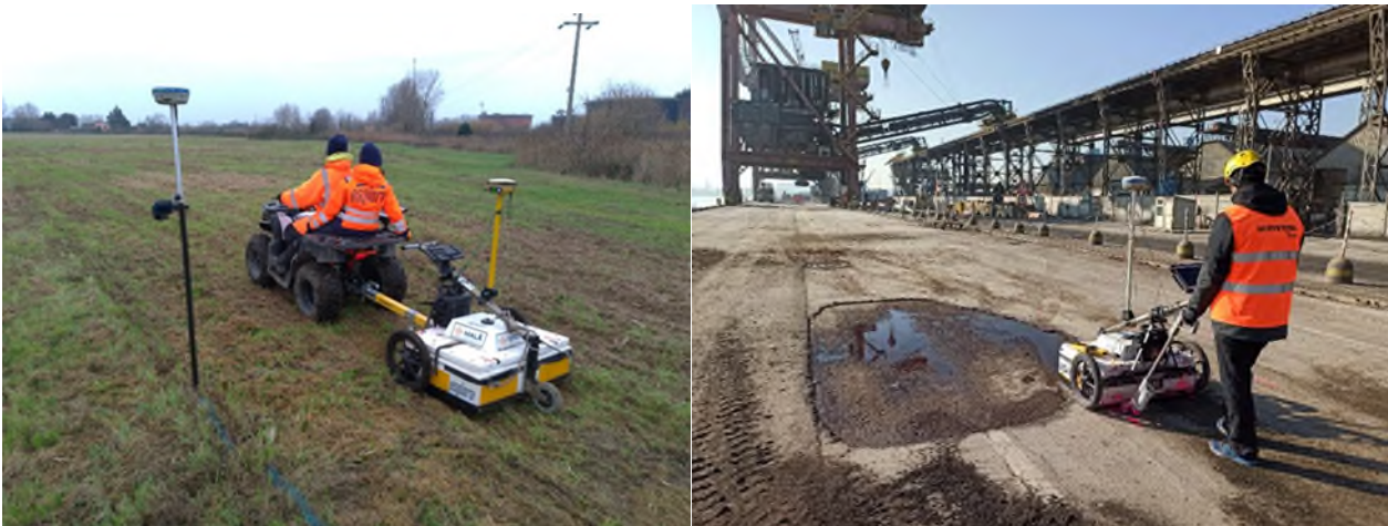
Figura 40: modalità di acquisizione a traino (a sinistra) e manuale (a destra)
