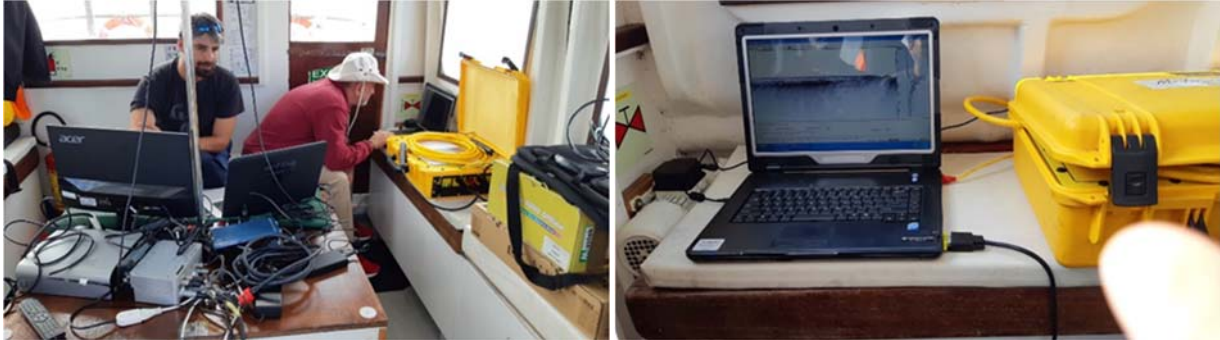
Figura 20: equipaggiamento per l'indagine SBP, collegata tramite seriale al sistema di navigazione
