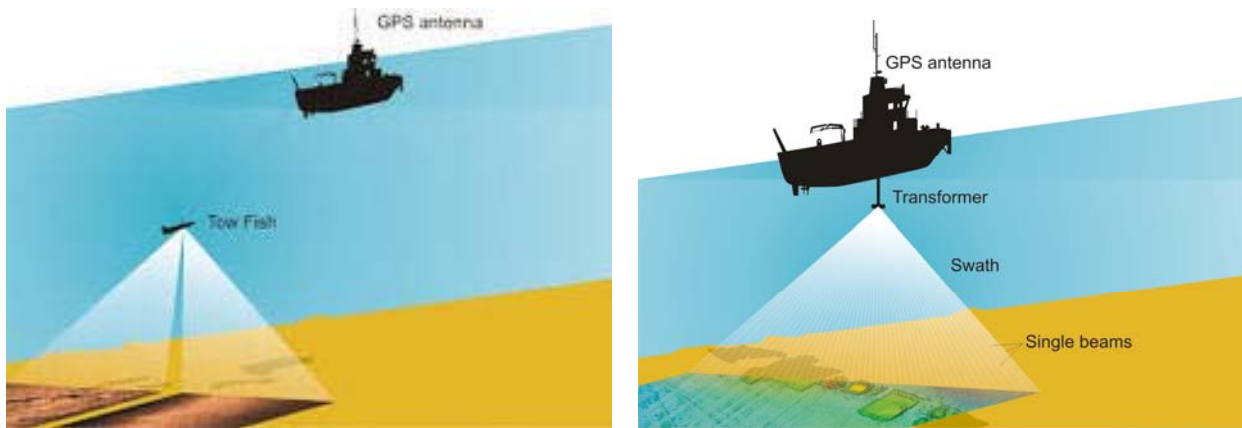
Figura 13: esempi di navigazione col sensore filato di poppa e “a palo”.
