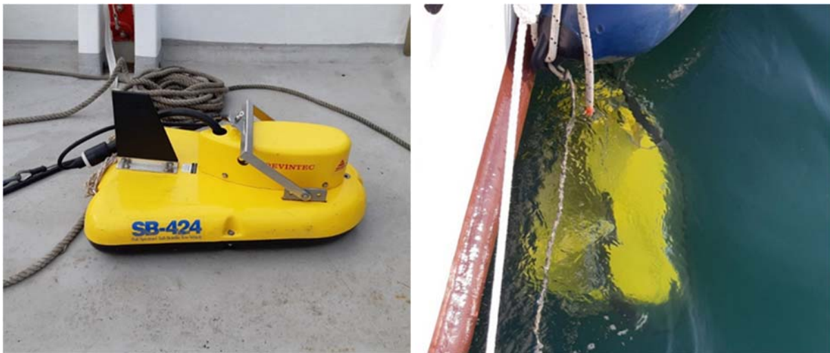
Figura 21: il trasduttore Chirp SB-424 collegato al sistema e filato a fianco della barca
