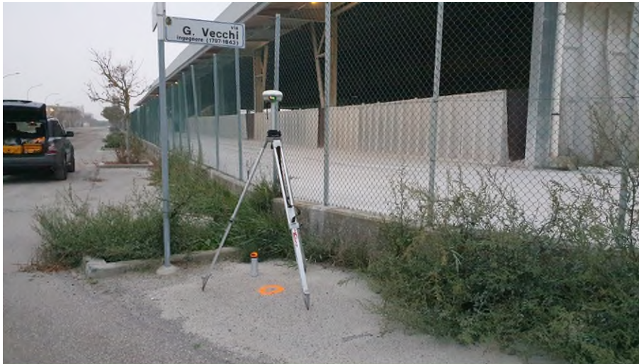
Figura 20: materializzazione e misura del caposaldo HUB13 presso la Cassa Nadep
