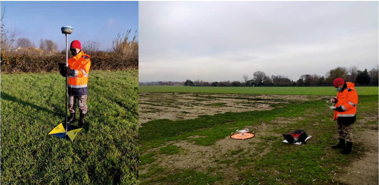
Figura 8: Fasi dell'acquisizione: rilevamento GCP (a sx), esecuzione del volo (a dx).
