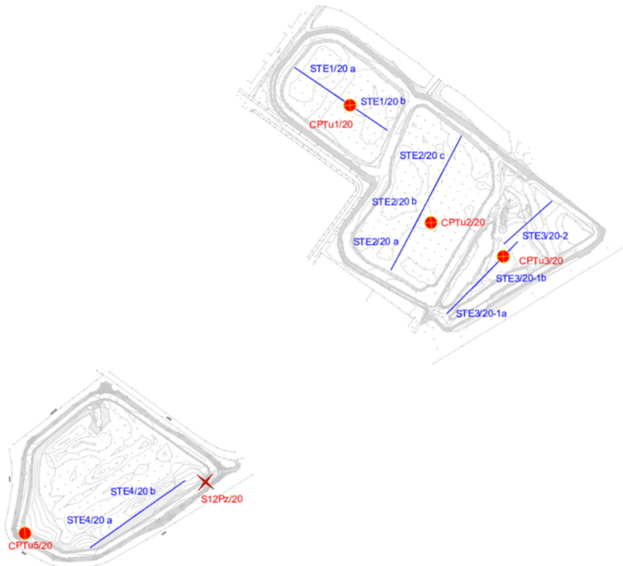
Figura 39: ubicazione stendimenti geoelettrici nelle casse di colmata
