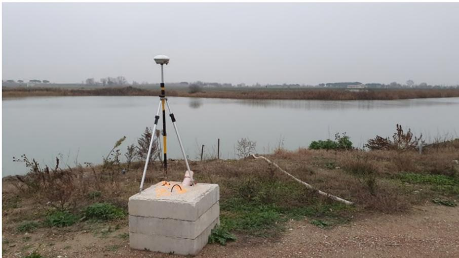
**Figura 32: materializzazione e misura del caposaldo HUB\_CB2 presso la Cava Bosca**
