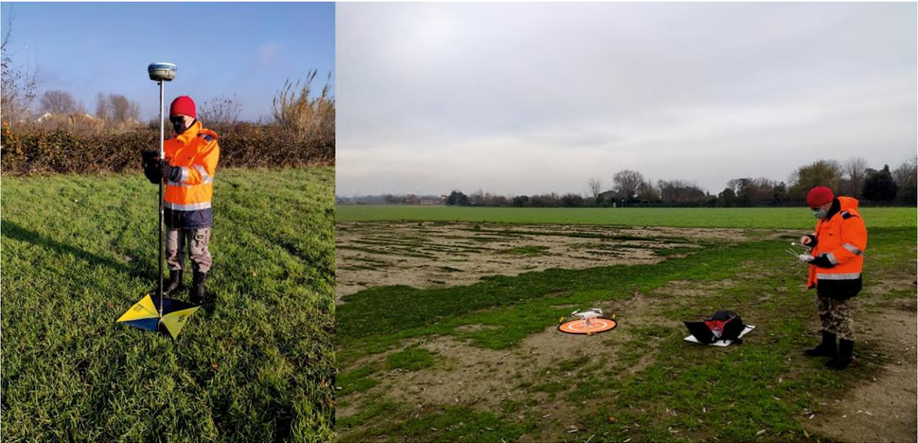
**Figura 8: Fasi dell'acquisizione: rilevamento GCP (a sx), esecuzione del volo (a dx).**
