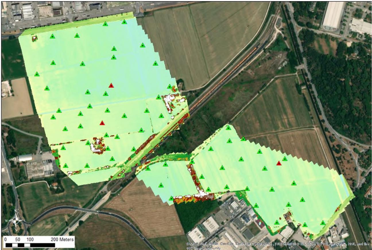
**Figura 57 Distribuzione dei GCP e Check Point all'interno dell'ambito rilevato**
