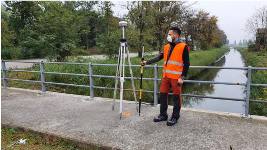
**Figura 30: materializzazione e misura del caposaldo HUB04 presso la Logistica S3**
