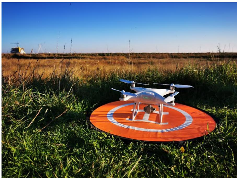
Figura 6: Il DJI Phantom 4 Pro, UAS utilizzato per i rilievi aerofotogrammetrici.
