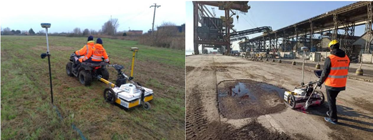
**Figura 27: modalità di acquisizione a traino (a sinistra) e manuale (a destra)**
