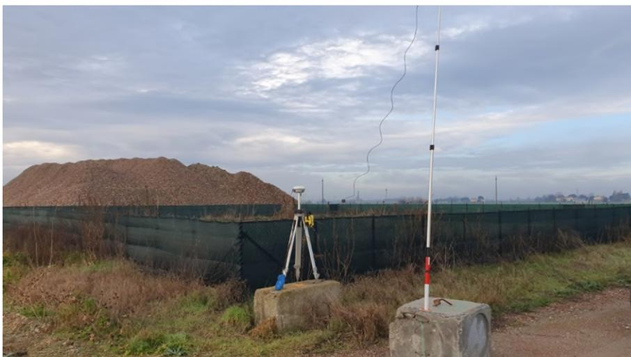
**Figura 33: installazione di una base GNSS sul vertici HUB\_CB1**
