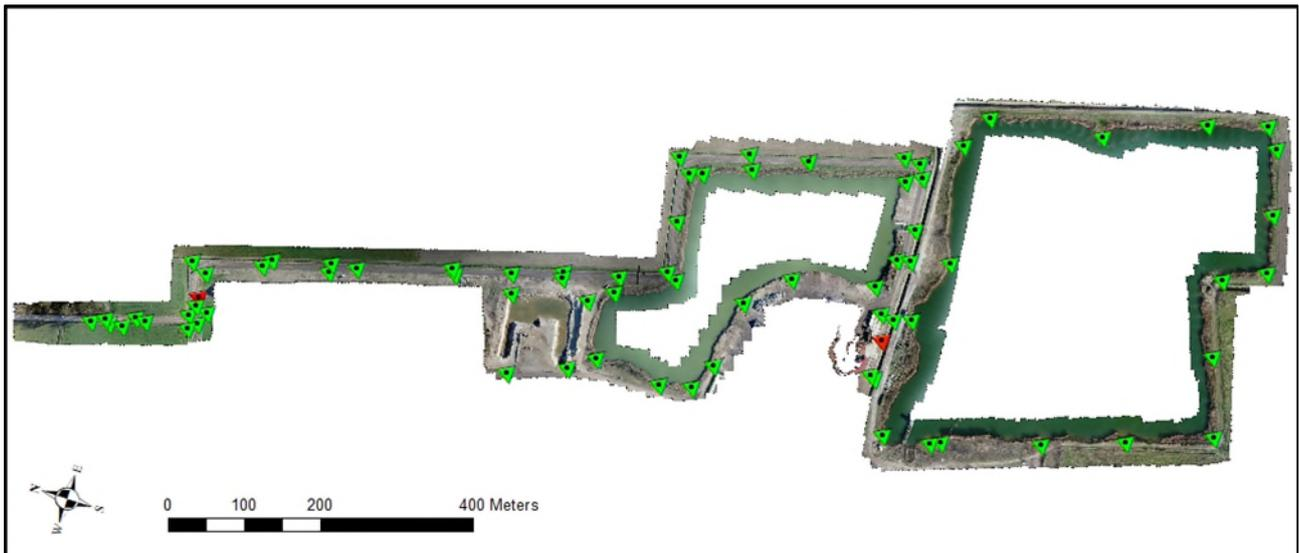
**Figura 63: Distribuzione dei GCP e Check Point all'interno dell'ambito rilevato**
