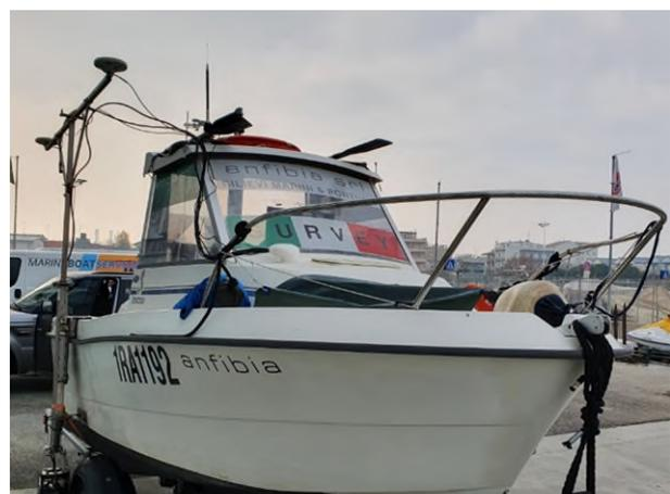
Figura 18: la testa (a sx) e l’intero supporto (a dx) del sistema multi beam Norbit iWBMS
