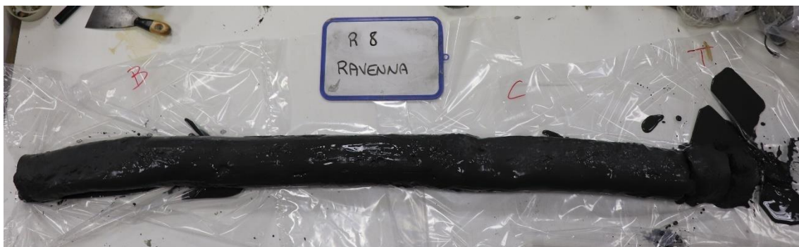
Figura 10: Campione indisturbato R8 al momento dell'estrusione.
