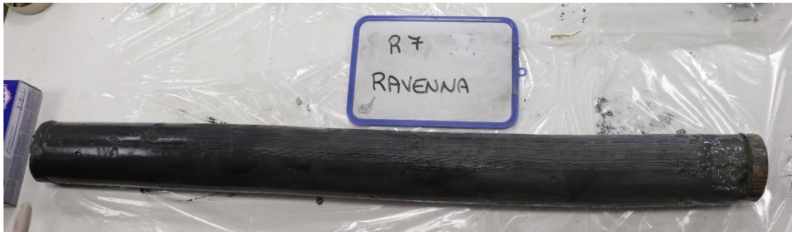
Figura 9: Campione indisturbato R7 al momento dell'estrusione.
