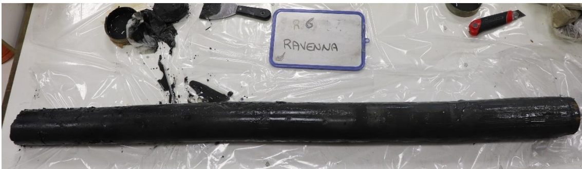
Figura 8: Campione indisturbato R6 al momento dell'estrusione.
