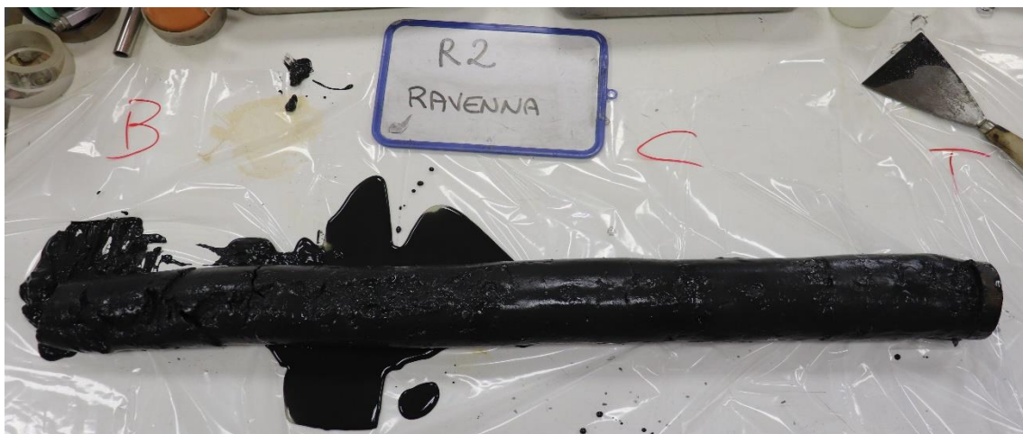
Figura 4: Campione indisturbato R2 al momento dell'estrusione.
