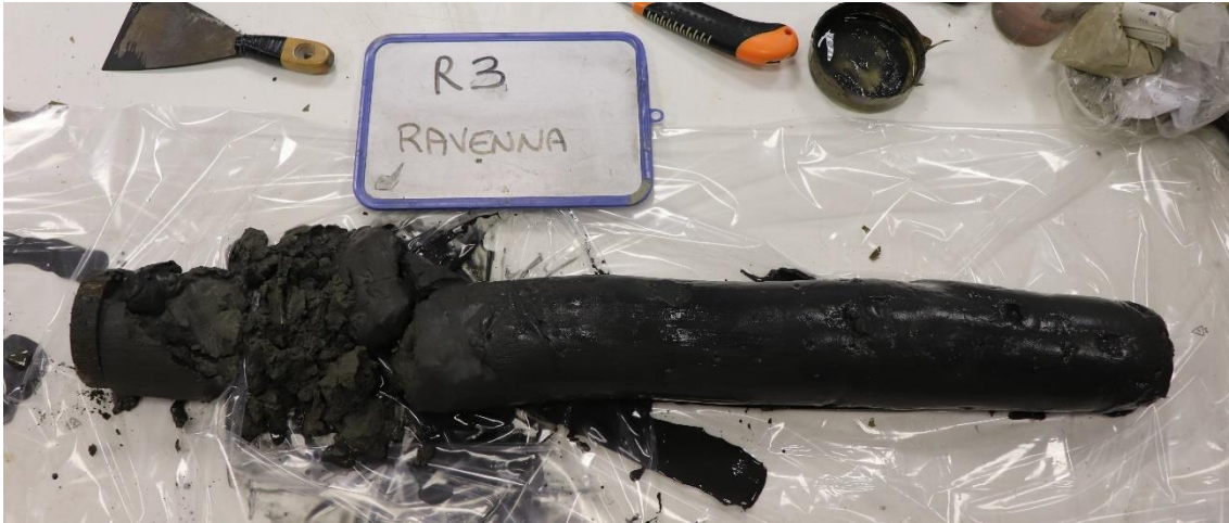
Figura 5: Campione indisturbato R3 al momento dell'estrusione.
