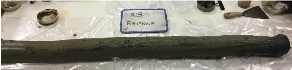
Figura 7: Campione indisturbato R5 al momento dell'estrusione.
