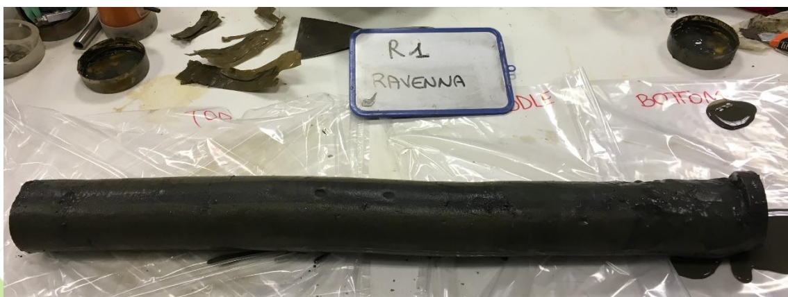
Figura 3: Campione indisturbato R1 al momento dell'estrusione.
