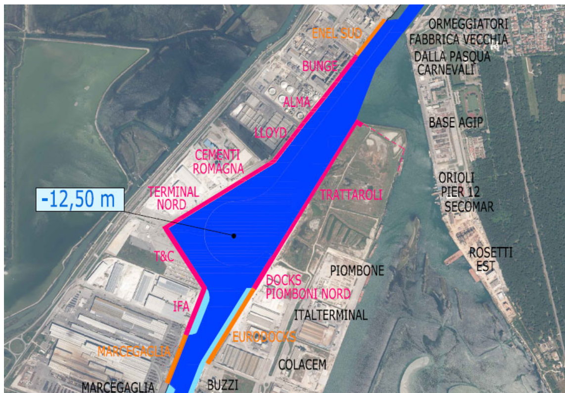
Figura 2 – Planimetria relativa alle banchine da adeguare e al nuovo terminal in penisola Trattaroli (PD)
