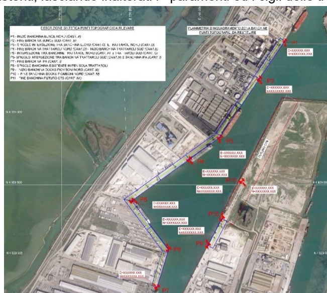
Figura 3 – Planimetria con ubicazione dei punti topografici significativi e identificazione aree rilievi banchine
