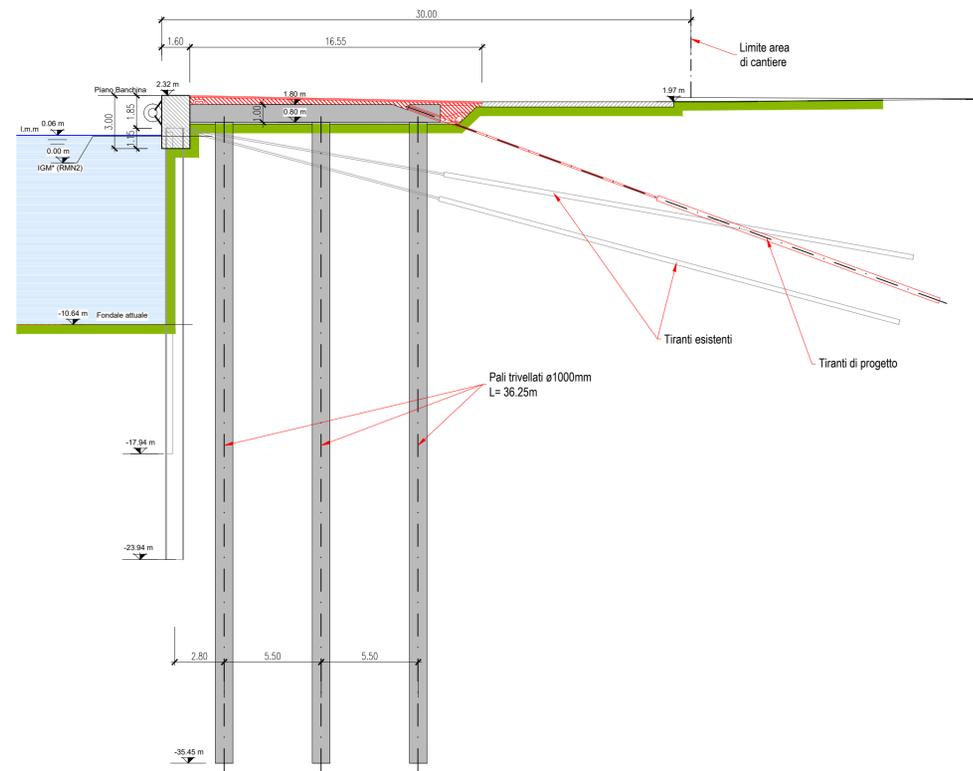
7. Realizzazione nuovi ancoraggi a bulbo iniettato: Barra autopercorante D=90mm, A=2470 mm<sup>2</sup> con bulbo in jet grouting (iniezione ad alta pressione), Ltot=32 m (Parte libera =15 m - Fondazione =17 m), inclinazione 20°, interasse =3.58 m
