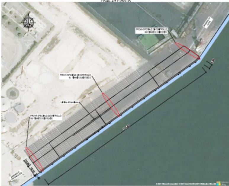
2. Conclusione di prova speciale di controllo su 3 ancoraggi esistenti (vedi in area centrale ed in area laterale sinistra immagine, come in foto in alto), mediante verifica di stabilità del filo presente sugli ancoraggi stessi, tramite una "prova di dimostrazione", e sulla verifica della capacità di carico di sbalzo di sistema in direzione ortogonale a quella di lavoro, mediante apposita sequenza di:
