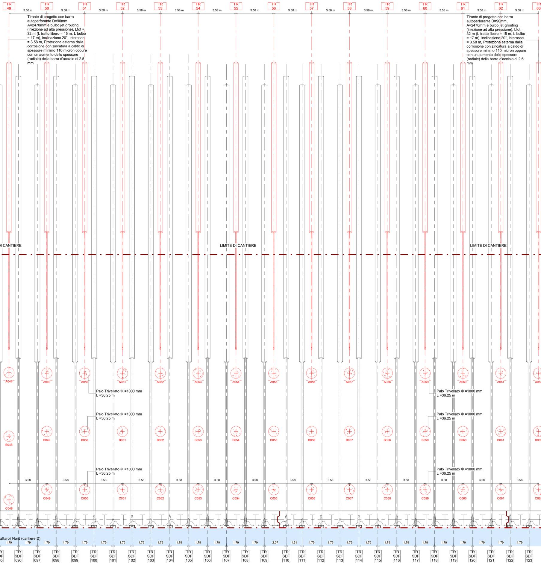
Tirante di progetto con barra autoperforante D=90mm, A=2470mm e bulbo jet grouting (iniezione ad alta pressione), Ltot = 32 m (L tratto libero = 15 m, L bulbo = 17 m), inclinazione 20°, interasse = 3.58 m. Protezione esterna dalla corrosione con zincatura a caldo di spessore minimo 110 micron oppure con un aumento dello spessore (radiale) della barra d'acciaio di 2.5 mm
