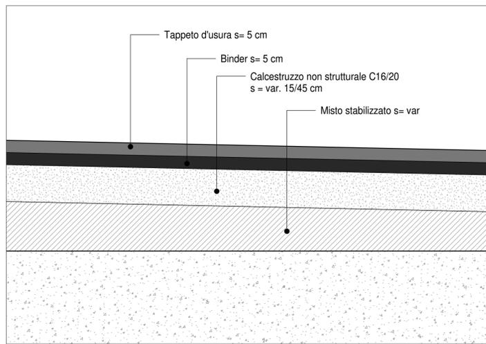
Particolare pavimentazione di progetto
