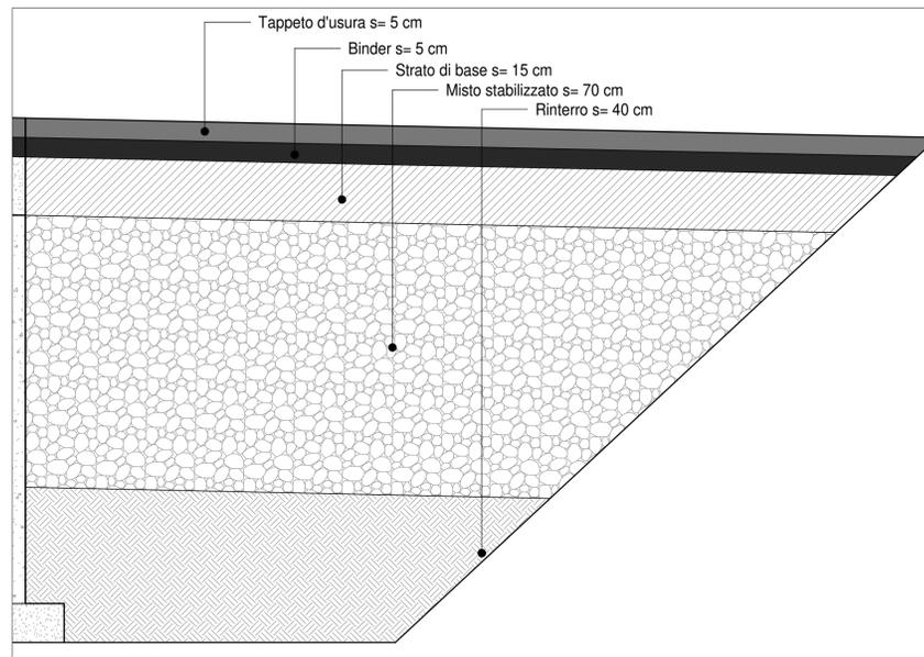
Particolare pavimentazione di raccordo
