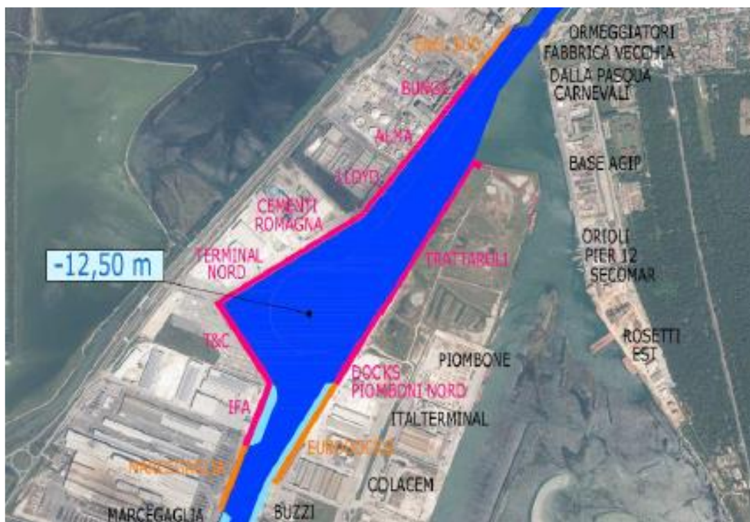
Figura 1 - Planimetria relativa alle banchine da adeguare e al nuovo terminal in penisola Trattaroli (PD)
