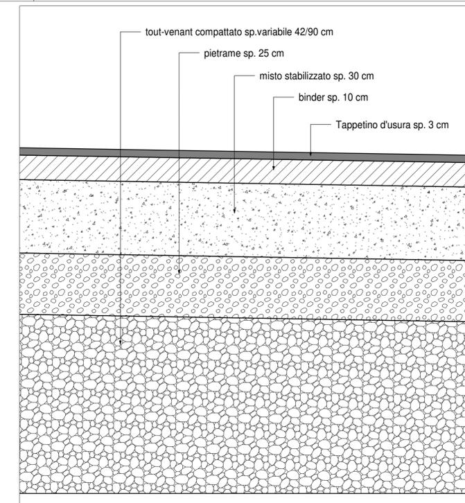
Particolare pavimentazione di progetto
