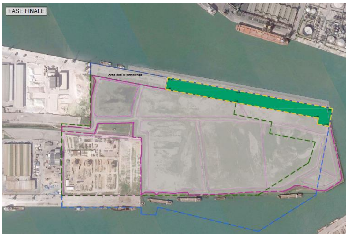
Figura 6 – Attività di Recupero rifiuti R5 EoW con movimentazione del materiale al sito di destino (L3), previo asporto argini.
