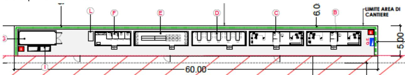
Analogamente in fase 2, con una diversa distribuzione si presenta l'area logistica pure di dim 60 x 5 m all'esterno dell'area operativa di cantiere
