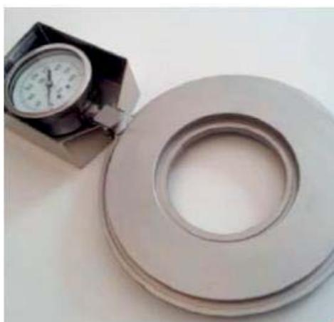
Figura 72 - Esempio di cella toroidale
