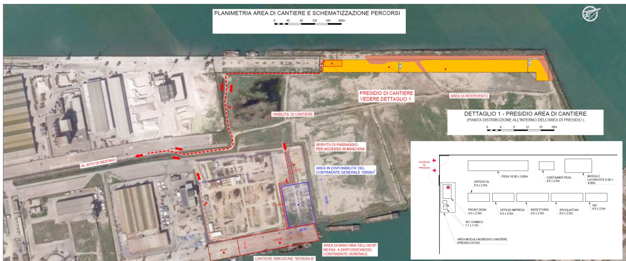
Figura 11 – Area Trattaroli – Aree e Percorsi di Cantiere
