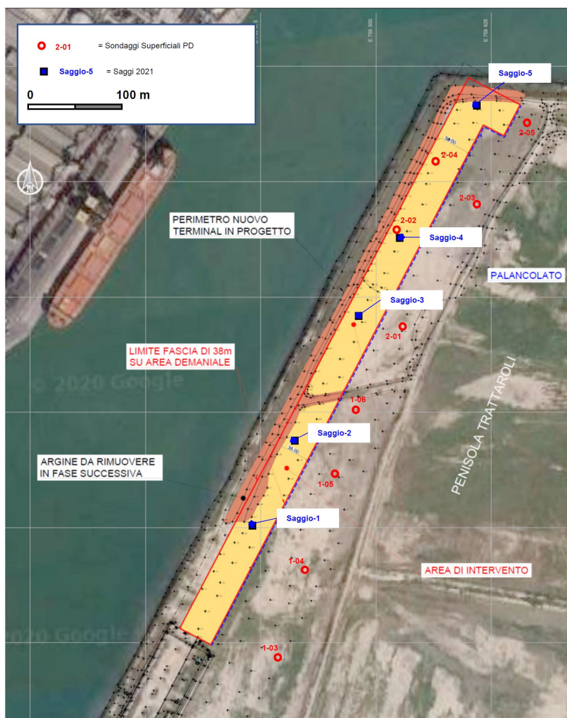
Figura 6 – Area Trattaroli - Indagini 2021 – Ubicazione saggi con escavatore in relazione a sondaggi da PD
