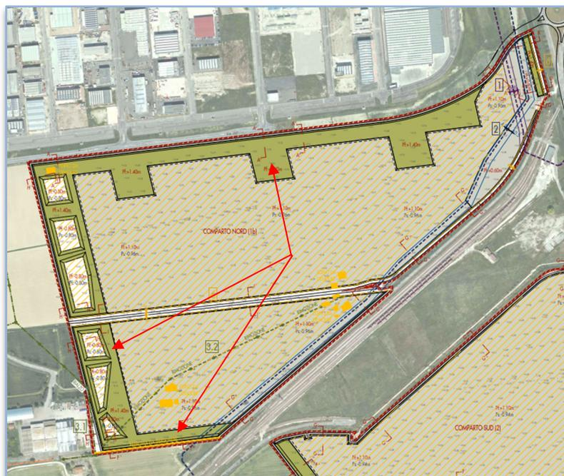
*Figura 3 – Comparto S3-Nord - Stralcio planimetrico della predisposizione dell'areale a terra con lo scotico dello strato agricolo per formazione delle aree a verde prima dell'avvio del riempimento con materiale di dragaggio (PD). Sono evidenziati (frecche rosse) gli argini perimetrali realizzati con il terreno superficiale scavato in sito*
