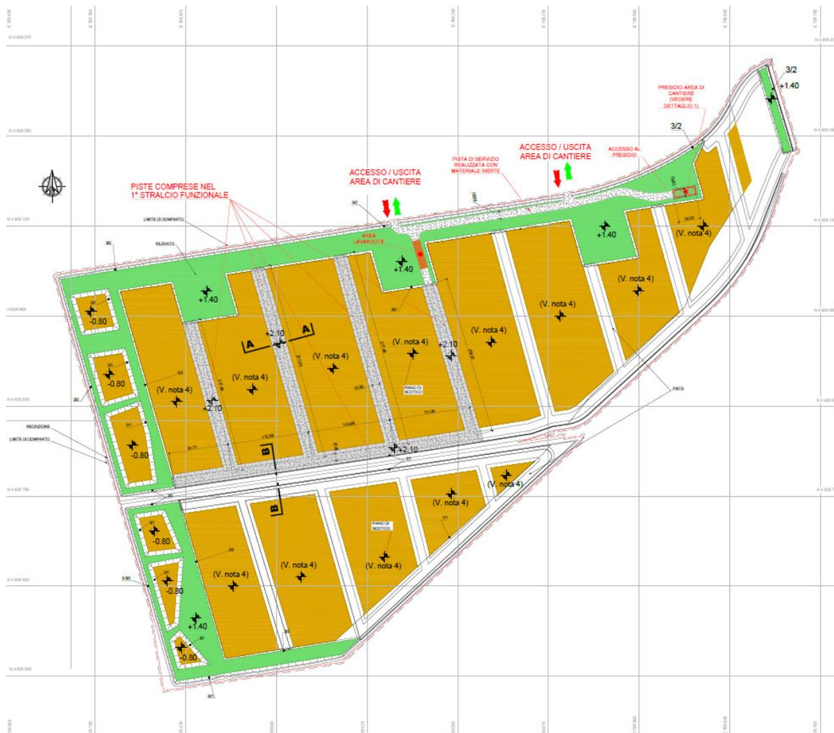
Figura 9 – Comparto S3 Nord – Stralcio planimetrico della predisposizione dell'areale a terra prima del riempimento con materiale di dragaggio
